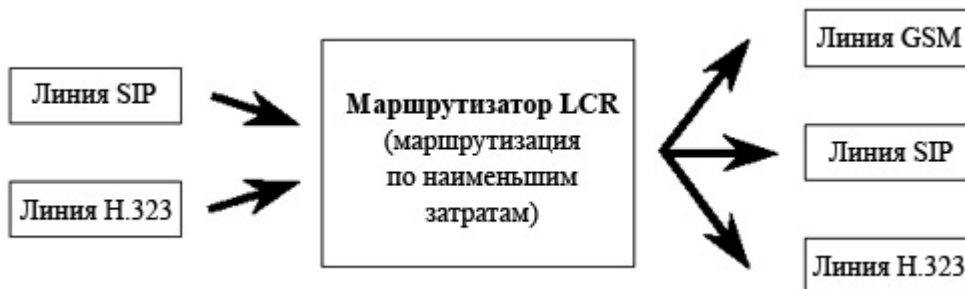
Рис. 26. Маршрутизация входящих вызовов из VoIP
