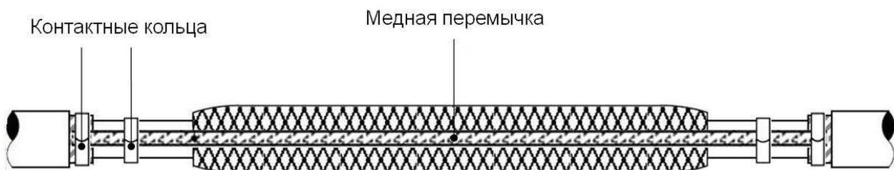
5.1. Установите медную перемычку (чулок из медной луженой сетки) поверх места ремонта и зафиксируйте ее с помощью пружинных контактных колец постоянного давления на металлической оболочке и стальной броне.
