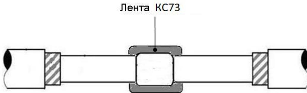
3.1. Поверх мастики в четыре прохода с половинным перекрытием наложите самослипающуюся силиконовую ленту КС73, как это показано на рис. 2. При намотке ленту следует растягивать с удлинением в 25-30%.
