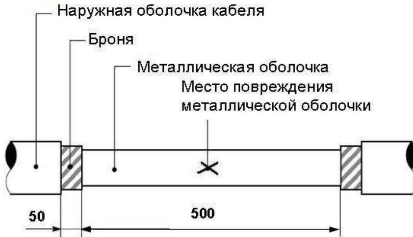
1.1. В области обнаружения течи масла из-под металлической оболочки кабеля удалите внешнюю оболочку кабеля и стальную броню согласно размерам, приведенным на рис 1. При этом место повреждения металлической оболочке должно быть как можно ближе к центру области ремонта.
