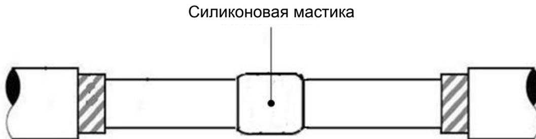
2.1. Возьмите силиконовую маслостопорную мастику Silicone putty kit и с прижимом оберните ею металлическую оболочку в области ее ремонта, как это показано на рис. 2.
