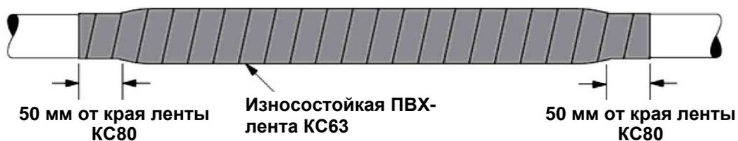
4.8.1 Наматывайте поверх места ремонта в четыре прохода с половинным перекрытием износостойкую ПВХ-ленту КС63. Намотку ленты следует начинать и заканчивать на оболочке кабеля, отступив 50 мм от края ранее намотанной ленты КС80. Последний виток ленты КС63 следует осуществлять без натяжения.
