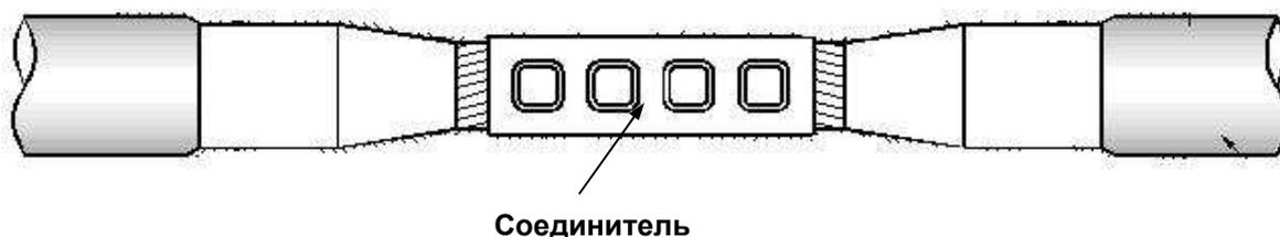
4.3.1 Установите на сращиваемую жилу соединитель и опрессуйте его. Очистите поверхность гильзы от заусенцев и тщательно удалите медную стружку.
