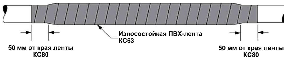
3.10.1 Наматывайте поверх места ремонта в четыре прохода с половинным перекрытием износостойкую ПВХ-ленту КС63. Намотку ленты следует начинать и заканчивать на оболочке кабеля, отступив 50 мм от края ранее намотанной ленты КС80. Последний виток ленты ПВХ-ленты КС63 следует осуществлять без натяжения.
