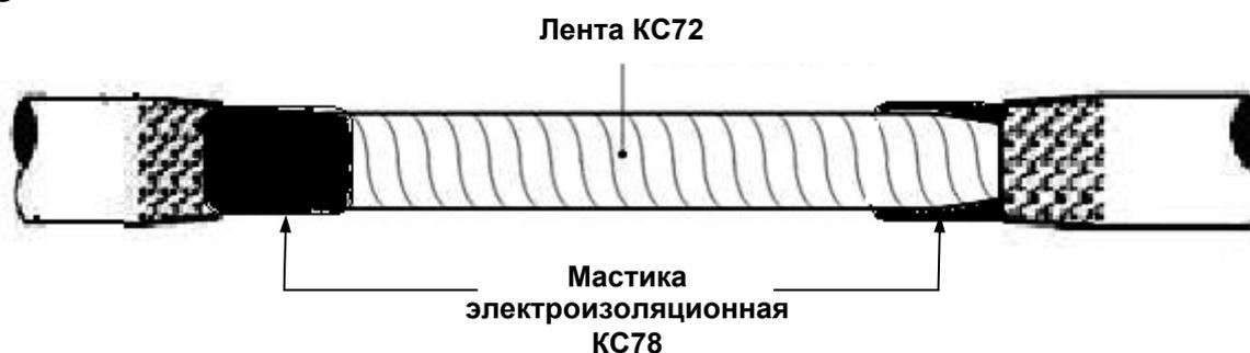
2.8.1 Намотайте вокруг жил в два слоя полупроводящую ленту КС72 с половинным перекрытием, начиная и заканчивая намотку на внутренней полупроводящей оболочке.
