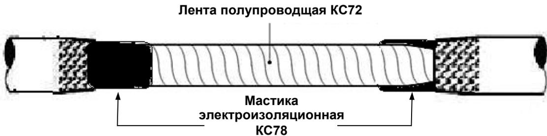
4.6.1 Наматывайте вокруг жил в два слоя полупроводящую ленту КС72 с половинным перекрытием, начиная и заканчивая намотку на внутренней полупроводящей оболочке.
