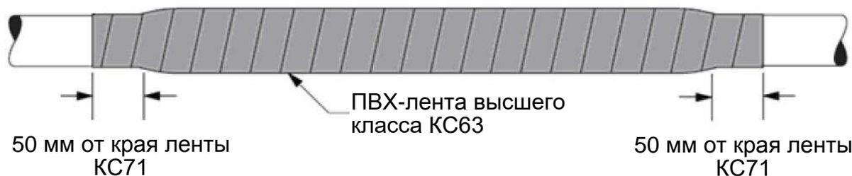
1.5.1. Намотайте поверх места ремонта в три прохода с половинным перекрытием износостойкую ПВХ-ленту КС63. Намотку ленты следует начинать и заканчивать на оболочке кабеля, отступив 50 мм от края ранее намотанной резиновой ленты КС71. Последний виток ленты КС63 следует осуществлять без натяжения.
