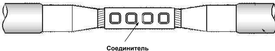
3.5.1 Установите на сращиваемую жилу соединитель и опрессуйте его. Очистите поверхность гильзы от заусенцев и тщательно удалите медную стружку.
