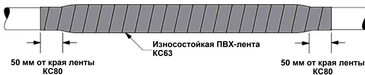
2.10.1 Наматывайте поверх места ремонта в четыре прохода с половинным перекрытием износостойкую изоляционную ПВХ-ленту КС63. Намотку ленты следует начинать и заканчивать на оболочке кабеля, отступив 50 мм от края ранее намотанной ленты КС80. Последний виток ПВХ-ленты КС63 следует осуществлять без натяжения.
