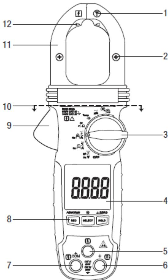
1. Антенна для бесконтактного обнаружения электрического поля.
