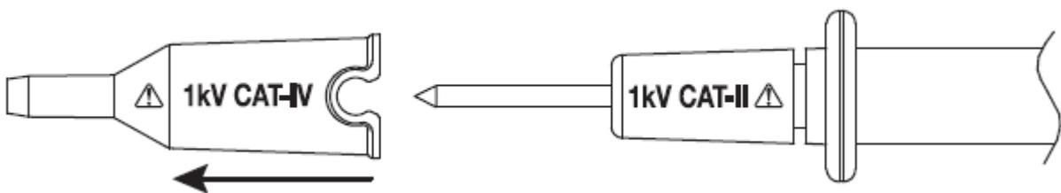
Насадку можно снять для использования в измерениях категории I или II.
