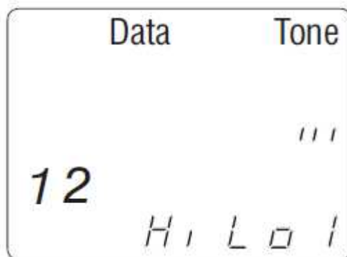
Рисунок 11. Режим тонального генератора для кабеля передачи данных и выбранного сигнала Hi-Lo1.
