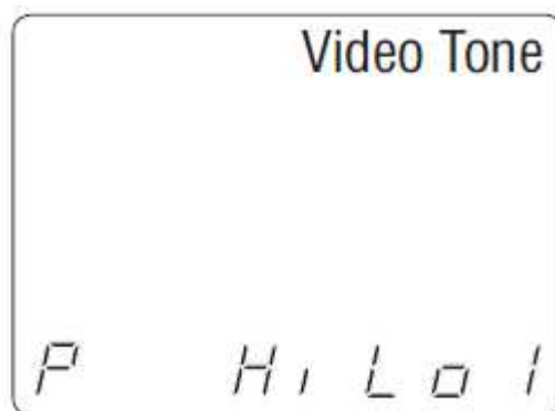
Рисунок 12. Тестирование видеокабеля с выбранным центральным проводником.
