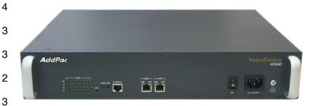
AddPac AP2640 представляет из себя модульный VoIP-шлюз, состоящий из шасси и 4 модулей для подключения к телефонным линиям (FXS, FXO, E&M, E1).
