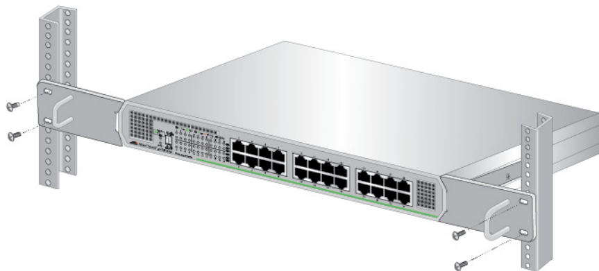
Рисунок 43. Установка коммутатора в стойку для оборудования
