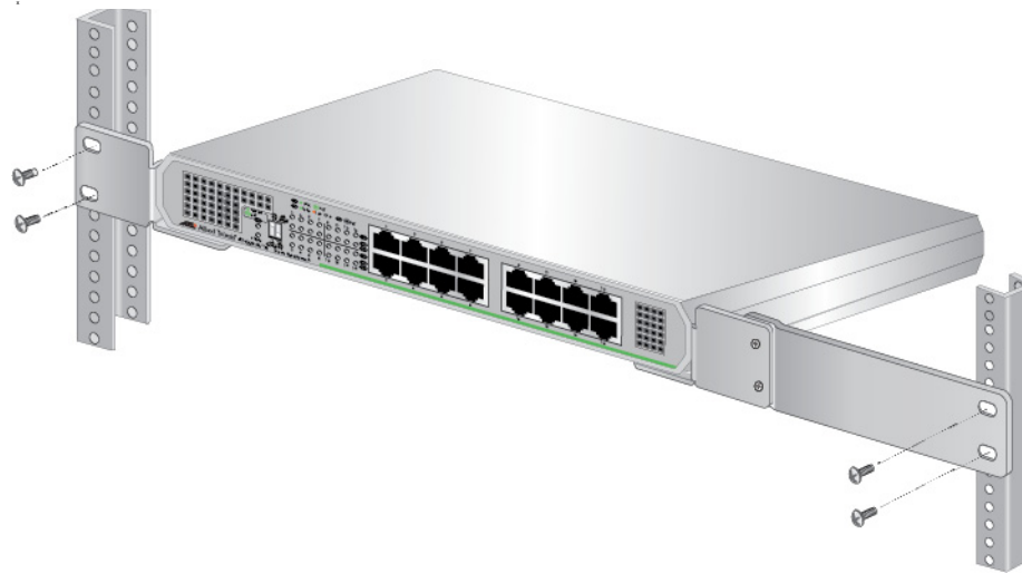
Рисунок 31. Установка коммутатора в стойку для оборудования
