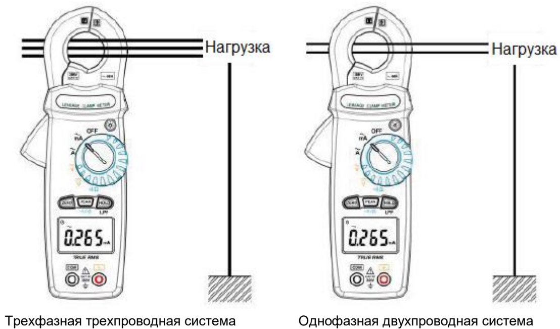
Рис. 2 Измерение дисбаланса тока утечки:
