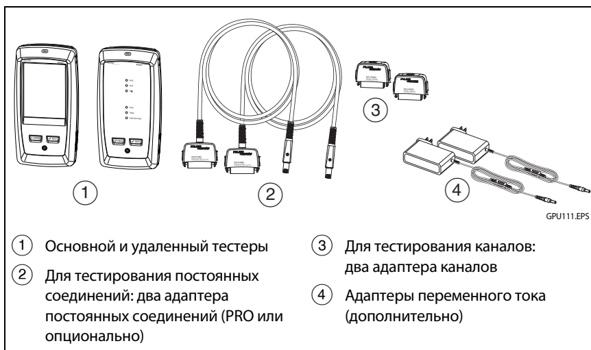
Рис. 12. Оборудование для автоматического тестирования витых пар
