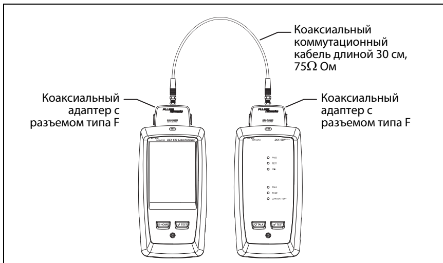
Рис. 21. Эталонные соединения для тестирования коаксиальных кабелей
