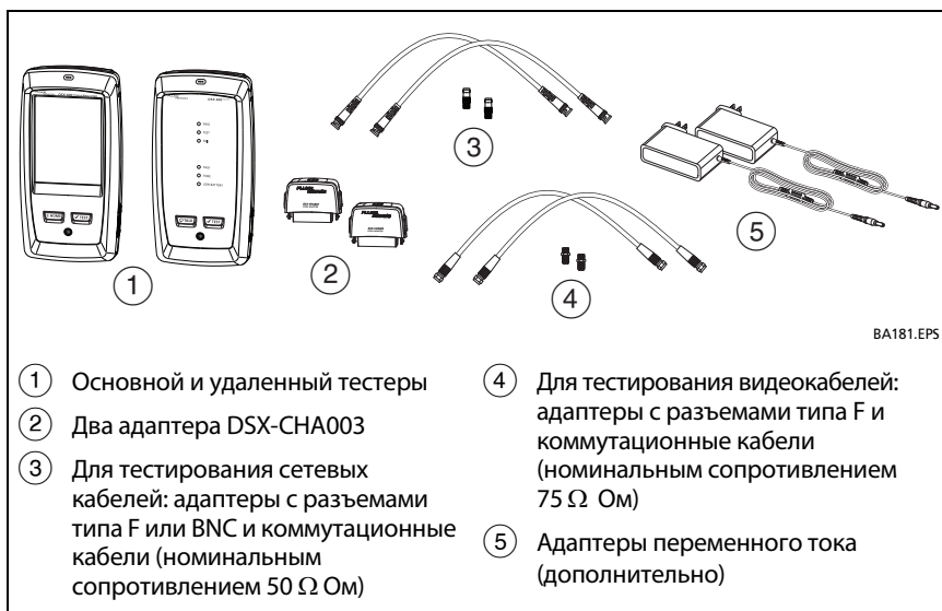
Рис. 22. Оборудование для тестирования коаксиальных кабелей
