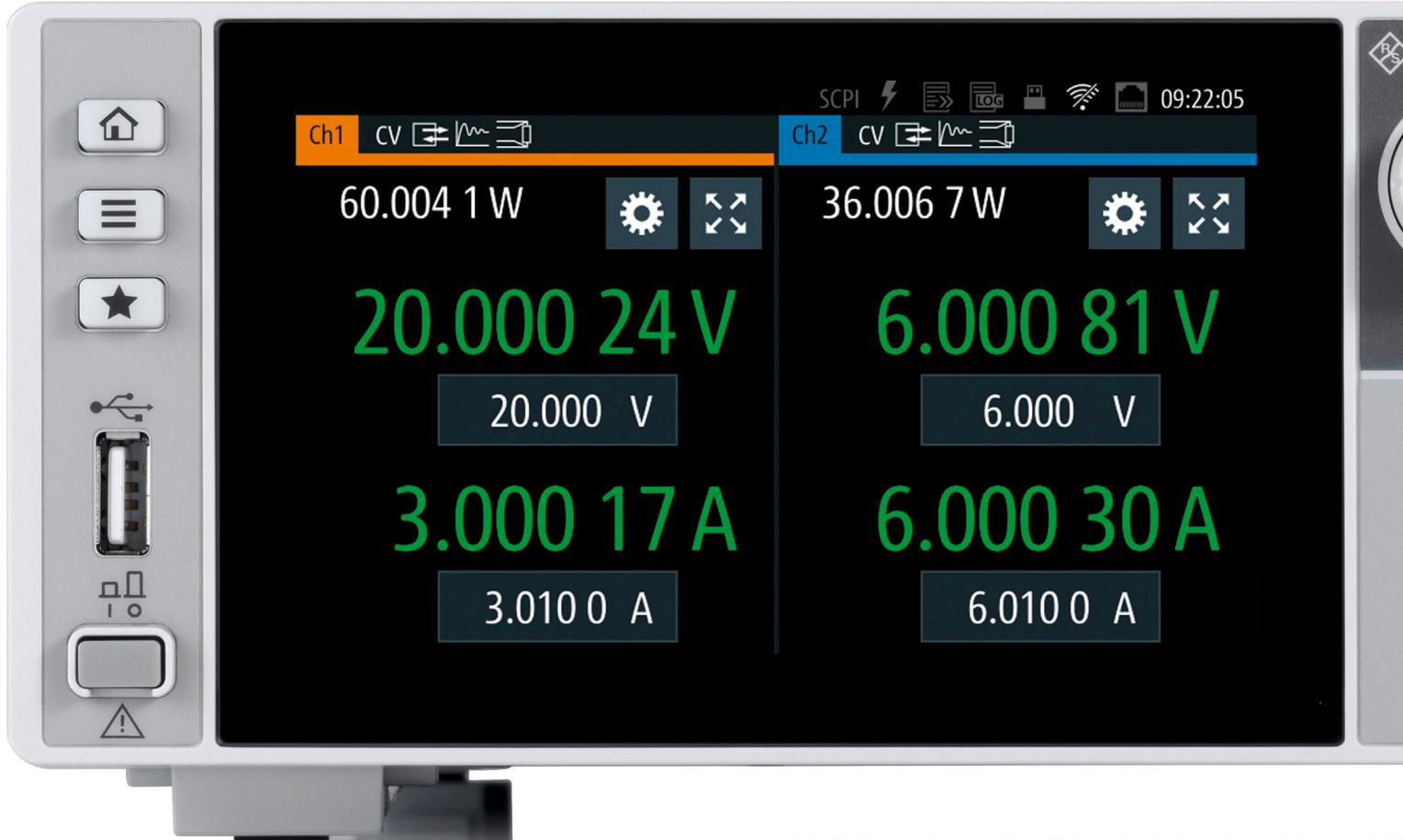
Линейная двухквadrантная конструкция выходных каскадов позволяет источникам питания из серии R&S®NGM200 работать в качестве источника и потребителя тока с минимальными уровнями остаточных пульсаций и шума, обеспечивая идеальную поддержку при разработке усилителей мощности и схем MMIC. Дополнительная функция имитации аккумулятора обеспечивает условия проведения испытаний, имитирующие использование реальной аккумуляторной батареи.
