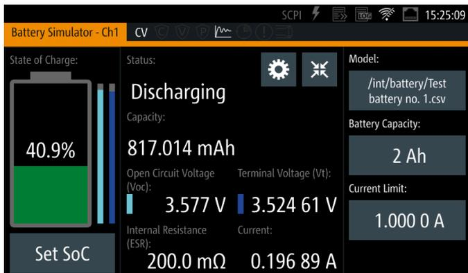
Программное обеспечение для имитации батареи содержит наборы данных для общих типов аккумуляторных батарей, которые легко изменить.
