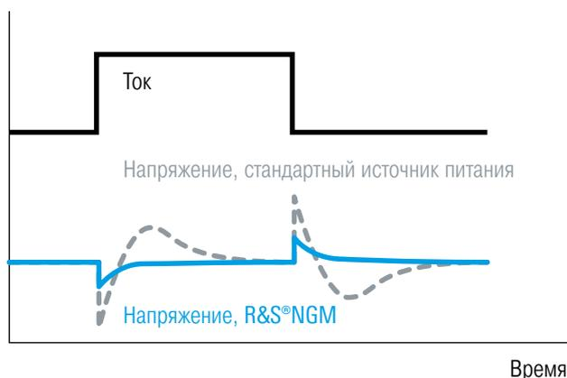
Источники питания обычно реагируют на резкое изменение нагрузки выбросом и медленным временем восстановления. Благодаря специально оптимизированным схемам управления источник питания серии R&S®NGM200 обеспечивает время восстановления менее 30 мкс.
