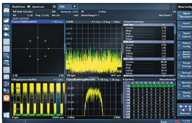
Демодуляция сигнала Bluetooth с помощью опции R&S®FPL1-K70
