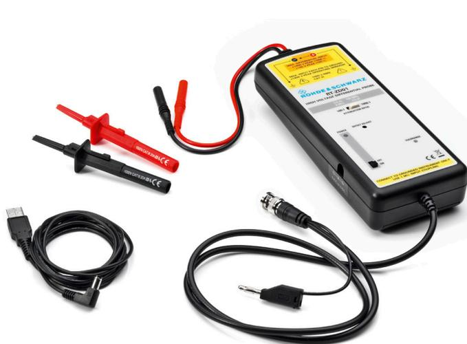
Высоковольтный дифференциальный пробник R&S®RT-ZD01 обеспечивает полосу пропускания 100 МГц для входных напряжений до 1400 В. BNC-интерфейс этого пробника делает его идеальным выбором для осциллографа R&S®RTB2000.
