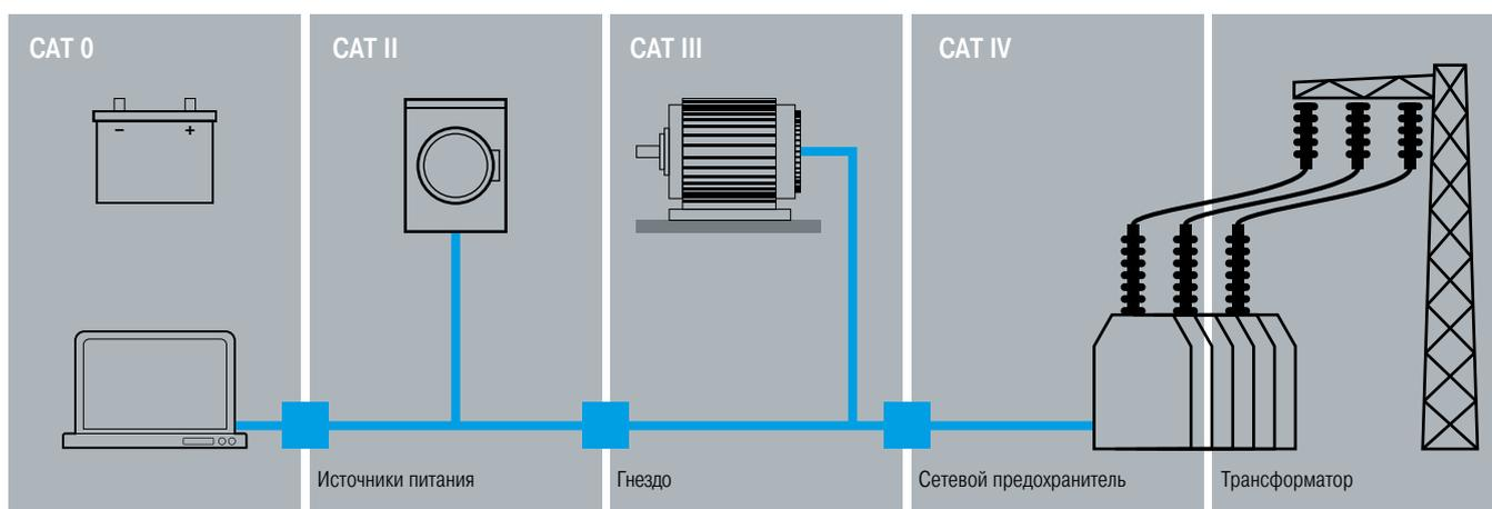
Конструкция пробника определяет область его применения и максимальное номинальное напряжение относительно защитного заземления.
