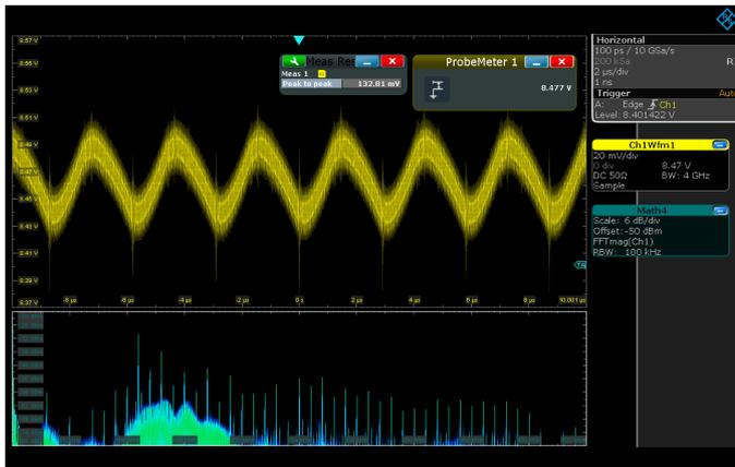
Широкая полоса пропускания пробника R&S®RT-ZPR позволяет захватывать даже высокочастотные шумовые составляющие, которые можно легко проанализировать с помощью функции спектрального анализа осциллографа R&S®RTO.
