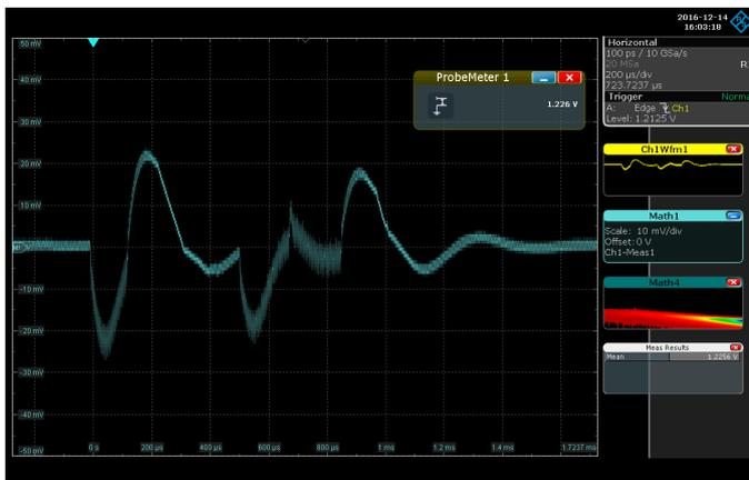
Возможность точной проверки уровня постоянного тока и реакции источника питания на нагрузку во время инициализации памяти DDR3 с помощью функции R&S®ProbeMeter и гибких математических функций осциллографа R&S®RTO.
