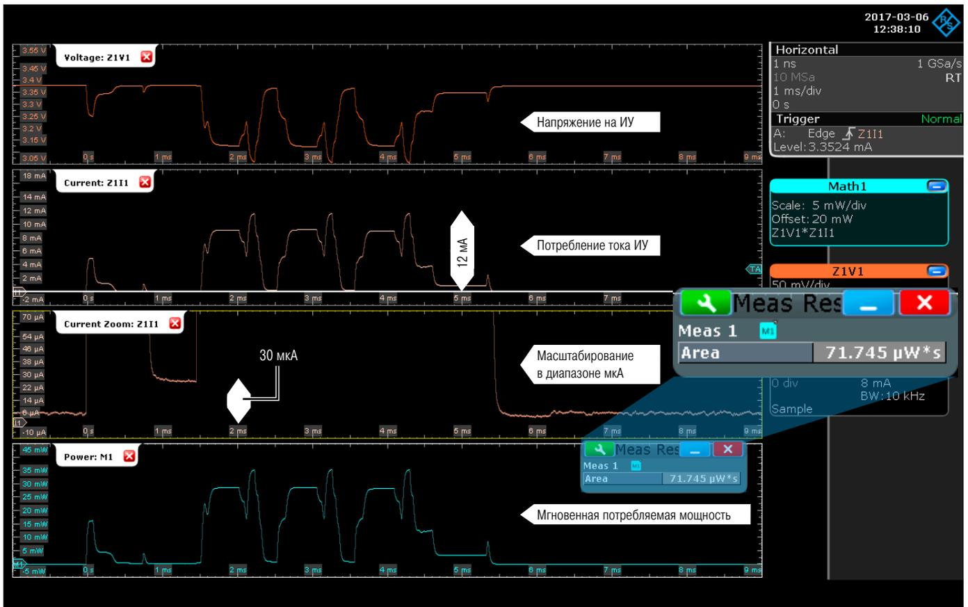
Пробник R&S®RT-ZVC обеспечивает чрезвычайно высокий динамический диапазон для измерения токов как в активном режиме, так и в спящем режиме, в данном примере 12 мА и 30 мкА. Автоматизированные измерения позволяют рассчитать общее потребление энергии.
