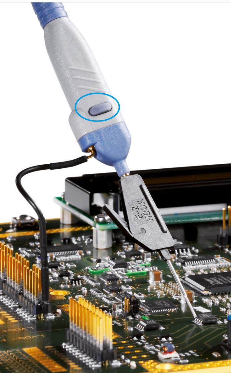
Практичная конструкция: микрокнопка обеспечивает удобное управление прибором. Разнообразные наконечники пробников и кабели заземления включены в стандартную комплектацию.
