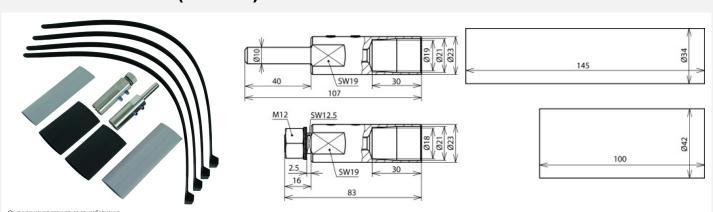
с обоих концов, соединение в зоне концевой заделки токоотвода с металлической трубостойкой осуществляется с помощью насадки (верхняя часть для соединительной пластины), соединение с другими элементами внешней системы молниезащиты или системы заземления - с помощью соединительного элемента (в комплект входят четыре термоусадочных трубки (две черного цвета, две серого цвета) и четыре кабельных стяжки).
