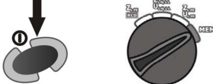
Включите измеритель. Установите поворотный переключатель в положение **MEM**.
