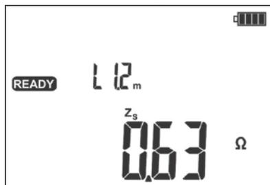
Главный результат измерения параметров петли короткого замыкания: полное сопротивление  $Z_s$  или ожидаемый ток короткого замыкания  $I_k$ .
