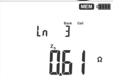
Установите нулевой номер ячейки в требуемом банке. На дисплее отобразится символ **dEt**, обозначающий удаление данных памяти.
