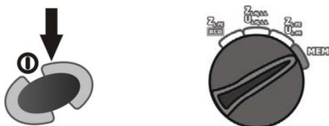
Включите измеритель. Установите поворотный переключатель в положение **MEM**.
