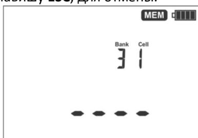
После подтверждения удаления, на дисплее отобразится быстрая смена номеров ячеек памяти, а по окончании, отобразится первая ячейка и прозвучит звуковой сигнал.
