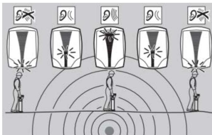
Определение точного местоположения подземного кабеля
