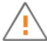
Восклицательный знак в треугольнике используется для предупреждения пользователя о наличии важных инструкций по эксплуатации и обслуживанию оборудования в прилагающейся к нему документации.
