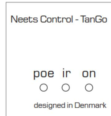
Светодиодный индикатор «он» отображает текущее состояние устройства.
