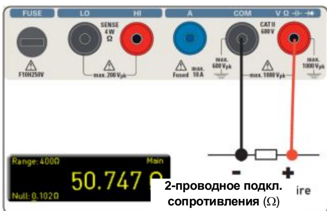
Рис. 7.4 – Измерение сопротивления (2-проводное)
