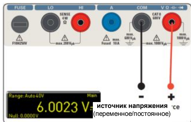
Рис. 7.1 – Измерение пост. или переменного напряжения
