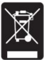
Рис. 12.4 – Маркировка изделия в соответствии со стандартом EN 50419
