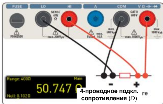
Рис. 7.5 – Измерение сопротивления (4-проводное)
