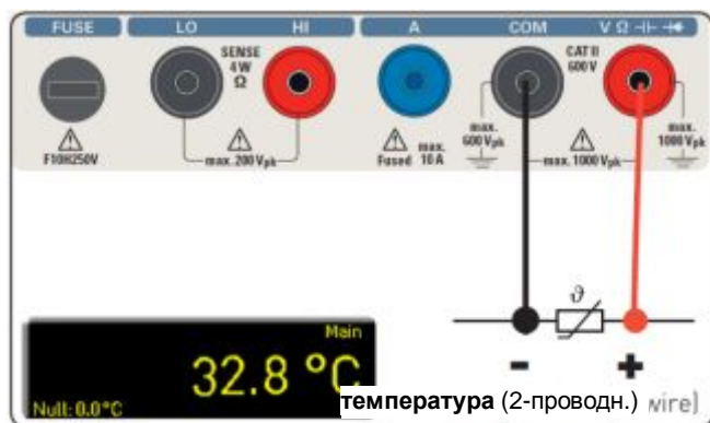
Рис. 7.7 – 2-проводное измерение с датчиком (температуры)
