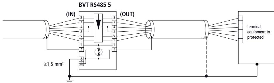
indirect shield earthing / indirekte Schirmerdung
