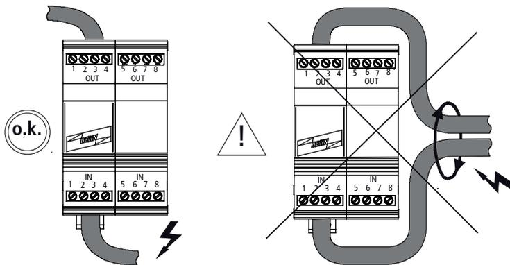
6 Test / Prüfung
