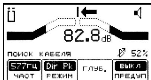
Приемник находится справа от отыскиваемой трассы
