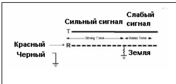
Рисунок 3. Подключите зажим красного цвета к поврежденному проводнику, зажим черного цвета к заземлению.
