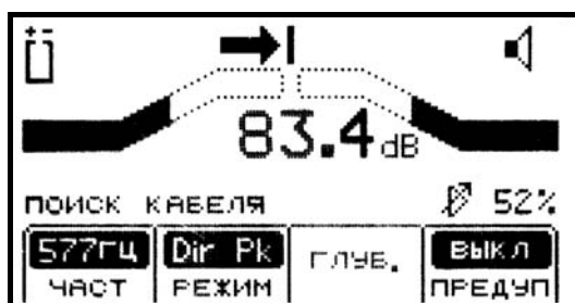
Приемник находится слева от отыскиваемой трассы
