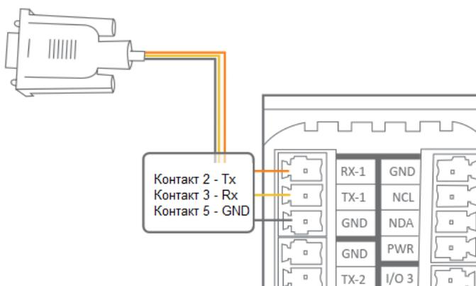
Порт RS-232 используется для однонаправленного или двунаправленного обмена данными. Двунаправленный порт используется для управления устройствами, отвечающими на команды. Подключите устройство EsHo Plus, как показано на рисунке.
