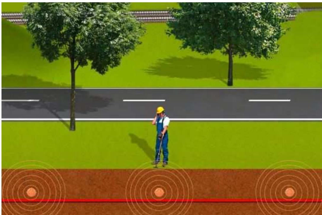
Рисунок 3 – Трассировка линейного участка при помощи электронных маркеров
