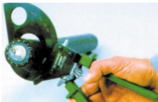
Рис.5: Инструмент для резки телефонных и коаксиальных кабелей
