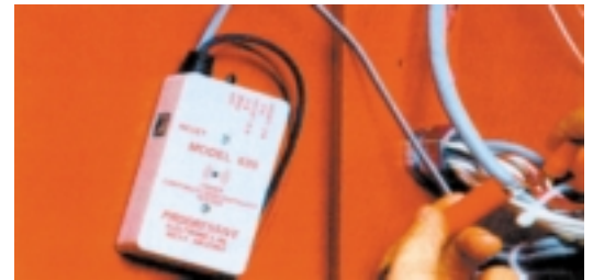
Рис.9: Тональный генератор и индуктивный щуп
