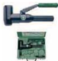
Идеально подходит для работы в стесненных условиях. Головка вращается на 180°, обеспечивая максимальное удобство при работе в труднодоступных местах. Сила выдавливания - 80 кН. В комплект входят шпильки 30043 и 31872, прокладка 03248, переходник 33967 и кейс 35202.
