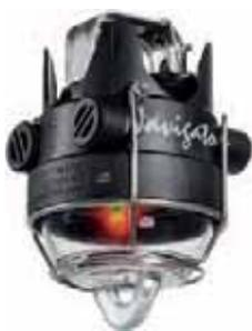
Индикатор неисправности воздушной линии SMART NAVIGATOR предназначен для интеллектуальных приложений автоматизации сети. Прибор устанавливается на воздушные линии передачи и распределения электроэнергии напряжением до 46 кВ, где он обеспечивает непрерывный сбор данных о линии и регистрацию событий (КЗ, ОЗЗ, отсутствие питания, отсутствие связи, температура).
