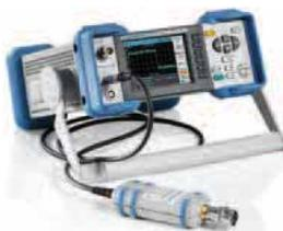
Устройство для измерения мощности радио сигнала с цифровой модуляцией (применяемой в современных системах мобильной радиосвязи, таких как WCDMA и WiMAX).
