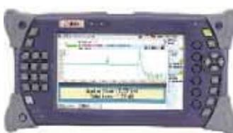
MTS-4000 - это модульный прибор, совмещающий в себе функциональные возможности оптического рефлектометра, анализатора xDSL и Ethernet сетей до 1G.
