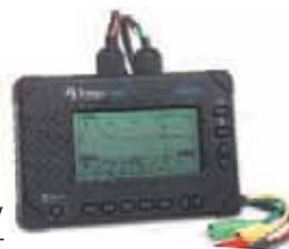
Рефлектометр обеспечивает дальность измерений до 10 км. При этом сохраняется высокая точность измерений (± 3 м). Прибор оборудован дисплеем с подсветкой (5,25”) и выполнен в ударопрочном и влагоустойчивом корпусе. Питается прибор от 6 батарей типа AA.
