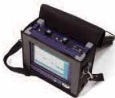
Модули OTDR MTS-6000/8000 позволяют локализовать любые неоднородности оптического волокна и проверить параметры мест сварки и коннекторов. Динамический диапазон модулей - от 24дБ (MM) до 50дБ (SM), самая короткая «мертвая зона» 80 см (VLR модуль). Рефлектометры обла-
