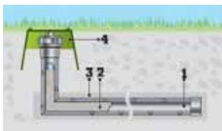
Комплекты электролитического заземления ZANDZ® предназначены для организации заземлителей в вечномерзлых, каменных и песчаных грунтах, обладающих высоким удельным сопротивлением (от 300 ом\*м), без применения специальной техники и насыпного грунта.
