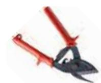
Jonard TS-850 - ножницы для продольного реза изоляции экранированного кабеля. Инструмент легко справляется с металлическим плетением или броней из гофрированной стальной ленты. Инструмент удобен при монтаже кабельных муфт для установок переходных соединителей экрана. Длина: 216 мм. Вес: 359 грам
