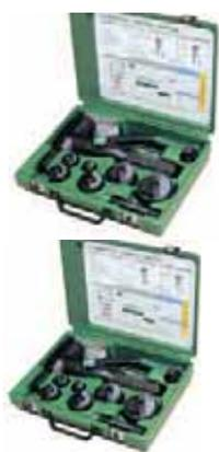
Гидравлические приводы используются для перфорации круглых отверстий диаметром до 64 мм и квадратных – размером до 68x68мм. Это идеальный инструмент для быстрого изготовления отверстий в листовых материалах. В наборах предлагаются ручные гидравлические приводы двух видов: прямой и угловой. Угловой привод имеет вращающуюся на 180 градусов голову для работы в труднодоступных местах. Сила выдавливания - 8,2 тонны (80кН).
