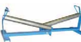
Приспособление применяется в качестве первого направляющего ролика после схода кабеля с барабана. За счет большой ширины роликов (680мм) препятствует соскальзыванию кабеля и гарантирует непрерывный процесс его размотки.
