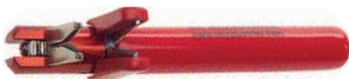
Инструмент для подготовки кабельных жил к накрутке или другим соединениям. Позволяет быстро и аккуратно снимать изоляцию и обрезать проводник на нужную длину. Инструмент прост и удобен в работе. Длина зачищаемого участка регулируется. Возможна работа с четырьмя жилами одновременно. Инструмент работает с проводниками диаметром от 0,25 до 0,65 мм. Предусмотрена замена лезвий.
