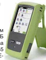
Тестер OneTouch снабжен сенсорным ЖК-дисплеем 14,5 см (5,7 дюйма), внутренней и внешней памятью 2 Гб и 4 Гб соответственно. Порты прибора: USB 2.0, два разъема RJ45 10/100/1000BASE-T, порт управления RJ45 10/100BASE-T, два сменных модуля SFP 100BASE-FX/1000BASE-X.
