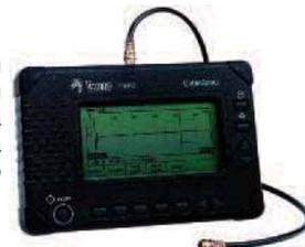
Результаты измерений отображаются на контрастном ЖК-дисплее со встроенной подсветкой. Прибор крайне легок в освоении. Для проведения измерений достаточно выбрать тип кабеля, а все остальное TV 90 сделает самостоятельно. Для тех, кто впервые пользуется прибором, предусмотрена система контекстно-зависимой справки.
