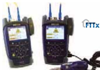
Эти тестеры предназначены для тестирования оптических линий в сетях FTТх стандартов ВРОН, ЕРОН, GРОН. Тестеры OLTS-85 совмещают в себе источник и измеритель оптической мощности. В зависимости от модели источник может быть двух или четырехволновым. OLTS-85 измеряет вносимые потери в линии.
