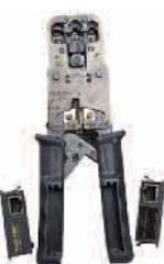
Tooltest - инструмент "2 в 1", который сочетает в себе функции кабельного (UTP/STP) тестера и инструмента для установки модульных разъемов RJ45/12/11. С помощью Tooltest сразу после установки модульного разъема можно проверить качество монтажа! Тестер позволяет определить такие неисправности как: короткое замыкание, перепутанные жилы в паре, целостность оболочки, а также определить правильность разводки.
