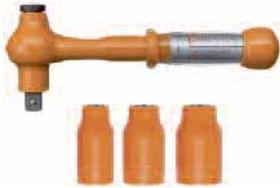
Динамометрические гаечные ключи позволяют произвести затяжку с заранее установленным усилием от 5 до 25 Нм. Ключи имеют диэлектрическое исполнение (до 1000 В) и адаптированы для работы совместно с головками 1/2 дюйма.
