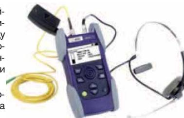
Оптические телефоны - устройства, предназначенные для организации дуплексной связи между операторами по неактивному волокну. Применяются во время монтажа и обслуживании оптоволоконных линий. Для соединения используется одномодовое волокно, рабочая длина волны - 1550нм.
