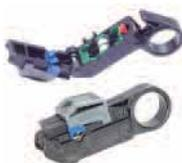
Трехуровневые стрипперы для работы с коаксиальным кабелем снабжены тремя лезвиями и позволяют снимать три слоя коаксиального кабеля за два движения. Длина зачищенного участка регулируется. Все инструменты работают с кабелем 2,5 – 7,6 мм. Обработанный кабель соответствует заводским стандартам установки разъемов. Длина инструментов 90мм, масса 40г.
