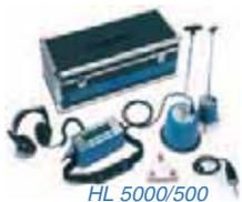
Приборы серии HYDROLUX 5000/500 предназначены для быстрой и точной локализации мест утечки в трубопроводе, а также локализации неисправностей и течей в неметаллических трубопроводах. Акустические шумы от места утечки регистрируются высокочувствительным микрофоном, а полученные сигналы отображаются на экране приемника в графическом виде.
