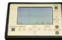
КБ Связь Сова - это комбинированный прибор для определения характера неисправностей и расстояния до места их возникновения в симметричных, коаксиальных и силовых кабелях. Он совмещает в себе импульсный рефлектометр и измерительный мост, что позволяет локализовать как низкоомные так и высокоомные повреждения.
