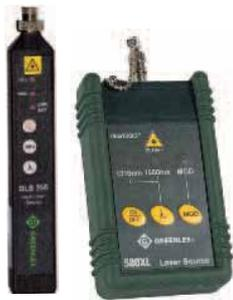
Источники излучения производства Greenlee (США) - это надежные, влаго устойчивые и ударопрочные приборы. Они хорошо зарекомендовали себя в Европе и России благодаря удобству эксплуатации, высоким техническим и эксплуатационным характеристикам. Greenlee предлагает две серии источников оптического излучения: 500XL и DLS. Каждая из них включает ряд приборов с различным набором рабочих длин волн, выходной мощностью, стабильностью и т.д.
