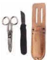
Миниатюрный поясной набор для монтажа кабеля включает ножницы монтажные, нож для разделки кабеля и чехол (кожа). Лезвия ножниц (ES-1964) имеют зубчатые края, предотвращающие выдавливание материала в процессе резки. Ножницы снабжены зачищающими V-образными прорезями для удаления изоляции с проводников. Нож (KN-7) имеет удобную рукоятку из полимерного материала, предотвращающего скольжение.
