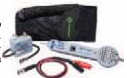
Генератор позволяет подавать в линию один из четырех различных звуковых сигналов. Сигнал генератора способен преодолеть на своем пути даже несколько пассивных устройств, таких как сплиттеры, направленные ответвители. Для подключения к линии применяется тестовый шнур с телевизионным разъемом или зажимы типа "крокодил".
