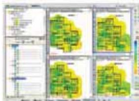
AirMagnet Survey – профессиональное решение для планирования и проектирования локальных беспроводных сетей стандартов 802.11a/b/g/n/ac. Система позволяет рассчитать необходимое количество, размещение и конфигурацию точек доступа при проектировании и внедрении WLAN.
