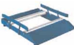
Ролики регулируются по длине и могут использоваться для размотки кабельных барабанов диаметром до 700 мм (KM-107134) и до 1000 мм (KM-107135). Для установки на приспособление барабан закатывается по небольшому пандусу. Поступательное движение разматывающегося кабеля приводит к плавному вращению барабана вокруг своей оси на роликах. Для замены кабельного барабана предусмотрена возможность блокировки роликов.
