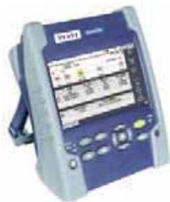
SmartOTDR – это портативный оптический рефлектометр с множеством дополнительных опций. Он позволяет выполнить детальную диагностику оптической линии: рефлектометрический анализ и локализация повреждений, определение вносимых потерь, визуализация повреждений и диагностика качества разъемов. Благодаря сервисной функции SLM (опция) результаты измерения представляются в простом для понимания виде, что не требует от специалиста глубоких знаний в области рефлектометрии.
