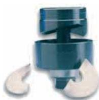
Перфоформы Slug-Buster состоят из пуансона, матрицы и шпильки для отверстий диаметром 12,5-64,0 мм. Особенностью данной серии перфоформ является наличие дополнительных режущих кромок в пуансоне. Благодаря этим кромкам высекаемая «шайба» разрезается пополам, что позволяет легко извлекать ее из матрицы. Рекомендуется применять смазку для шпилек Greenlee GT-1547 или аналогичную.
