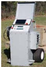
Системы для испытания кабеля от компании VON Corp предназначены для испытания кабеля повышенным напряжением на сверхнизкой частоте в соответствии с ТУ. В процессе испытания выявляются слабые места, которые в последствие приводят к выходу кабельной линии из строя. Установка снабжена системой для поиска повреждения методом отражения от электрической дуги, а также рефлектометром для определения расстояния до места повреждения.
