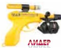
Ручной инструмент для прокладки кабеля на участках до 15 м внутри фальшпола, за фальш-потолками, в каналах вентиляции и в других ограниченных пространствах. При помощи пружинного механизма пистолет выстреливает дротик с прикрепленной леской. После этого, к дротику крепится кабель или вытяжной трос, который леской втягивается обратно. Пистолет удобен в обращении, оснащен катушкой с редуктором и креплением под фонарь.
