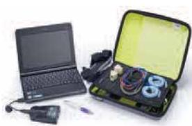
Анализатор протоколов AnyTest (Linkbit AT1000) одновременно тестирует два порта ISDN PRI (E1) и один порт Ethernet. Может работать как симулятор элементов сети NGN, Mobile, FMC, обеспечивать мультипротокольный генератор трафика (голос/данные). Имеет скоростное подключение USB 2.0
