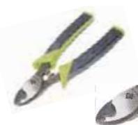
Кабелерез предназначен для обрезки медного кабеля сечением до 16 мм<sup>2</sup>: 4-х парный UTP, Coax RG58/ RG59, RG6/ RG6Q. Текстурированные рукоятки исключают проскальзывание инструмента в руке, встроенные ограничители предотвращают их «заклинивание» при сжатии, а острые лезвия не допускают заломов кабеля при обрезке.
