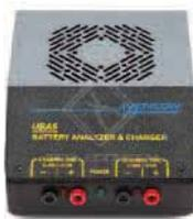
Vencon UBA5 – это тестер аккумуляторных батарей, совмещенный в одном корпусе с зарядным устройством. Vencon UBA5 позволяет измерять напряжение, ёмкость, внутреннее сопротивление и температуру аккумулятора, оценить его состояние и спрогнозировать срок службы. Прибор полностью программируемый, что позволяет задавать определенную программу теста аккумулятора.
