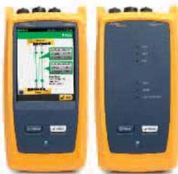
Анализатор CertiFiber Pro выполнен на базе универсальной модульной платформы Versiv и предназначен для тестирования и сертификации волоконно-оптических кабельных систем.
