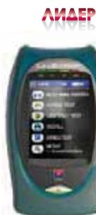
Сетевой анализатор LANEXPERT предназначен для мониторинга, обслуживания и устранения неполадок в сетях Ethernet (10/100/1000BaseTX).
