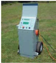
Системы VON Corp. предназначены для испытания кабеля переменным напряжением на частоте 0,1 Гц. Установки смонтированы в надежном металлическом корпусе с колесной тележкой и могут быть укомплектованы специальной крепежной системой для размещения в автомобиле. На передней панели прибора расположены органы управления и экран для отображения результатов тестирования.
