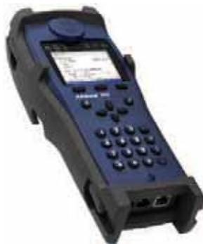
Многофункциональный тестер ARGUS 156 производится в трех базовых модификациях: с интерфейсами ISDN PRI, VDSL2 (Profile 35b и Super Vectoring) или SHDSL.
