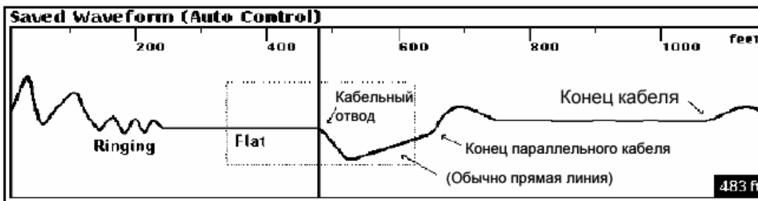
Рисунок 7-3. Пример рефлектограммы для кабельного отвода и параллельного кабеля.
