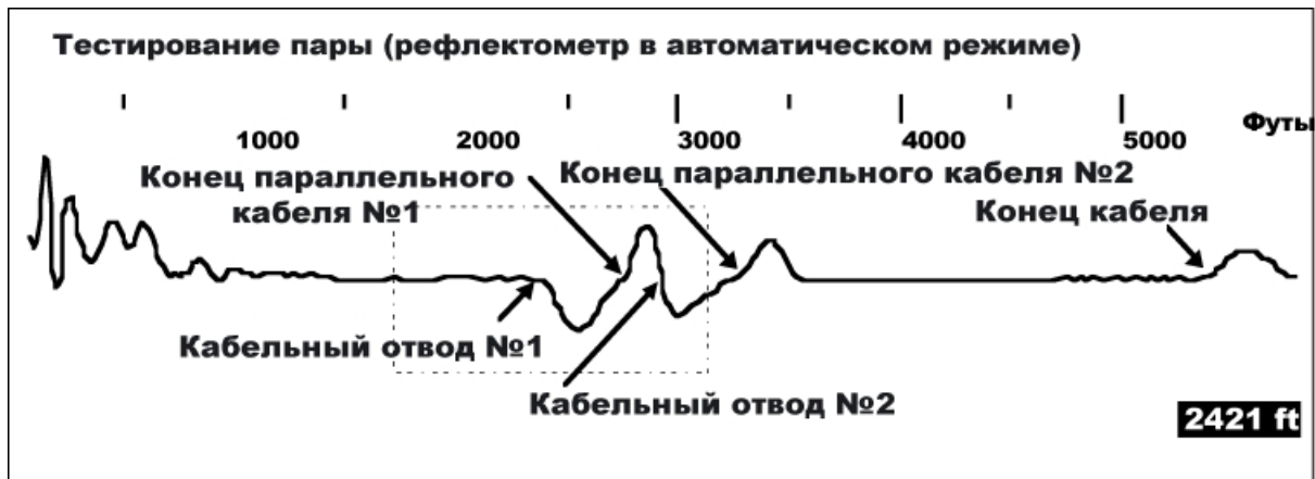
Рисунок 17-15. Пример рефлектограммы для нескольких кабельных отводов и параллельных кабелей.
