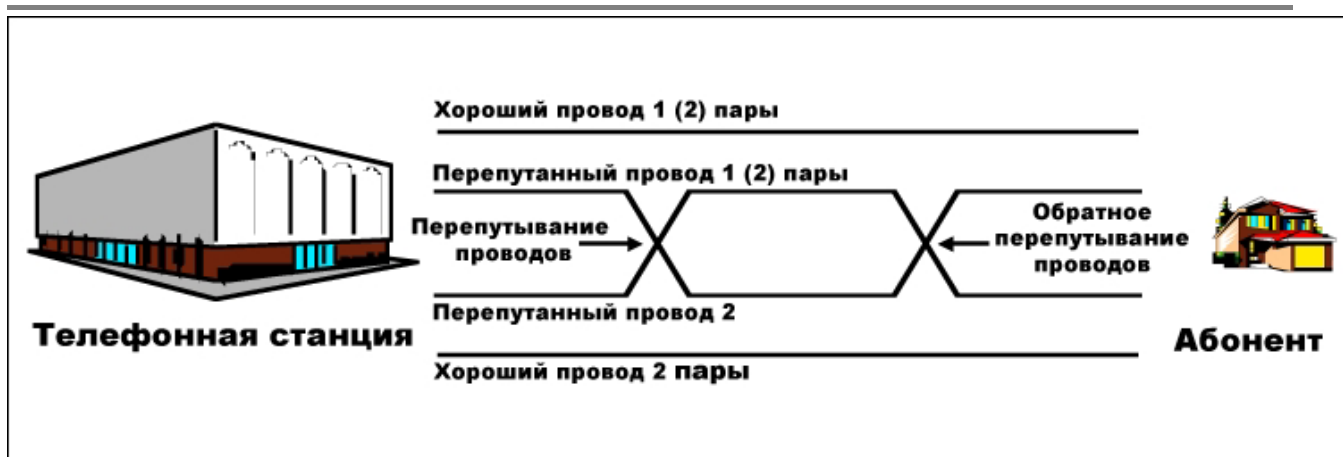
Рисунок 8-1. Перепутывание и обратное перепутывание проводов пары.
