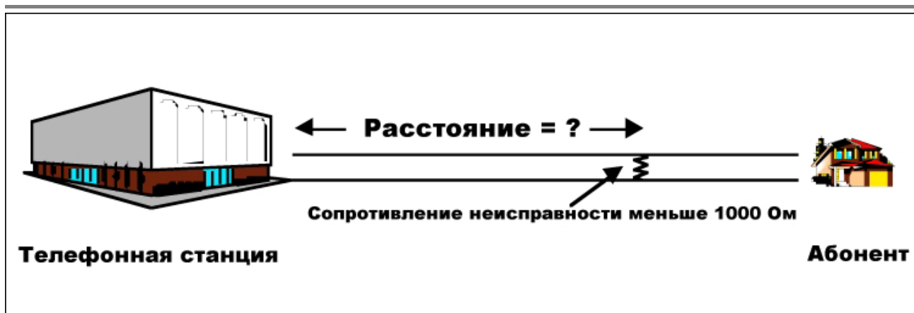
Рисунок 5-5. Низкоомное короткое замыкание (до 1000 Ом).
