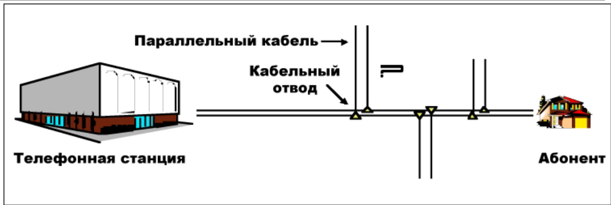
Рисунок 17-17. Самый длинный кабельный отвод.
