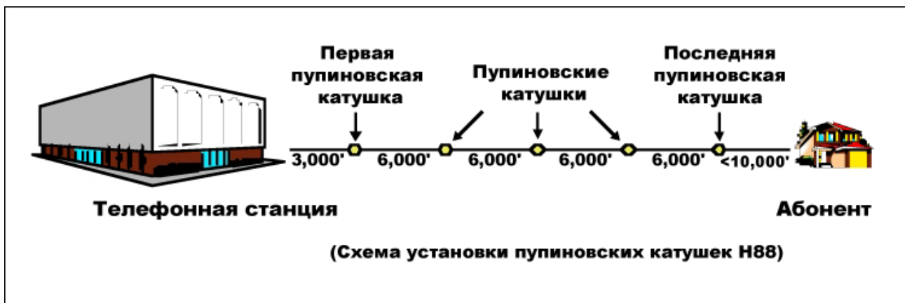
Рисунок 6-2. Схема установки пупиновских катушек.
