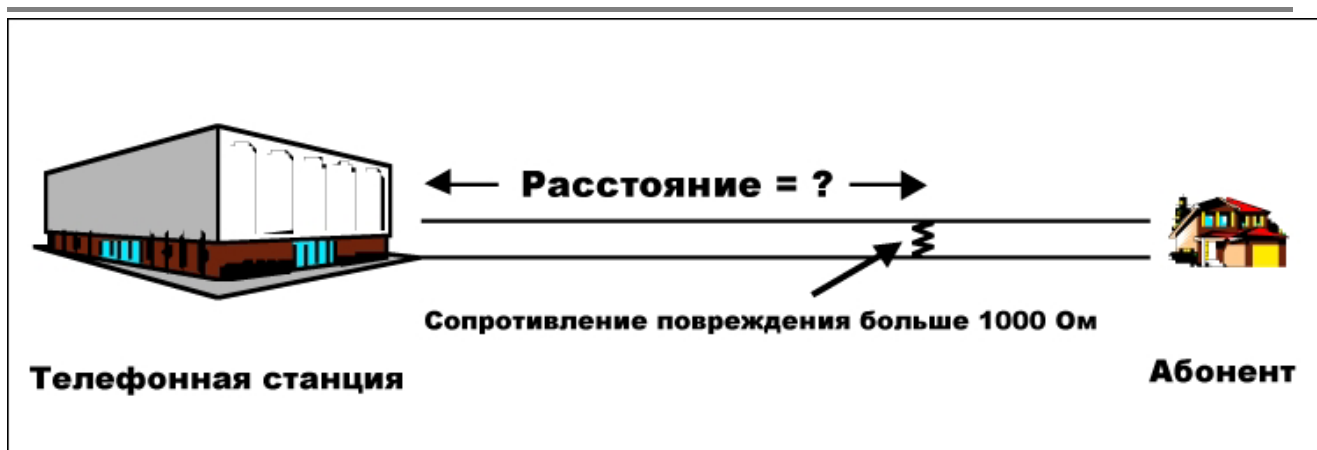
Рисунок 5-9. Высокоомное короткое замыкание (более 1000 Ом).
