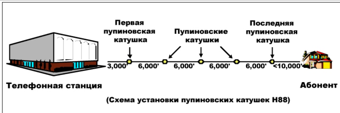
Рисунок 3-6. Кабель с установленными пупиновскими катушками.
