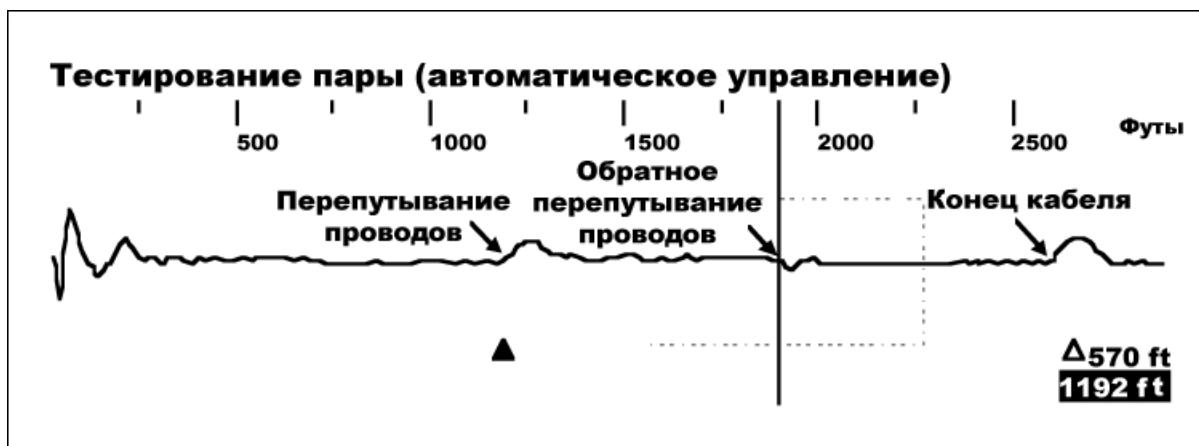
Рисунок 17-22. Пример перепутывания и обратного перепутывания проводов пары.
