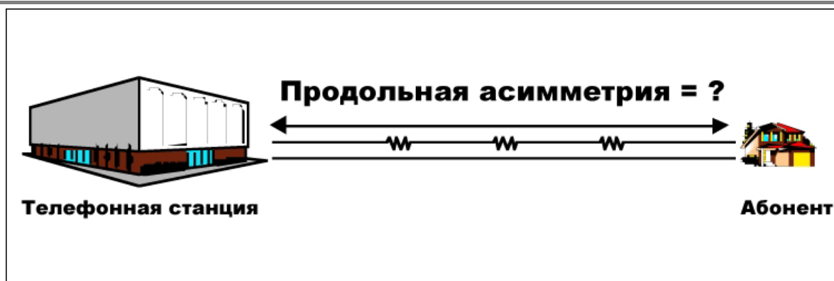
Рисунок 3-8. Продольная асимметрия линии.
