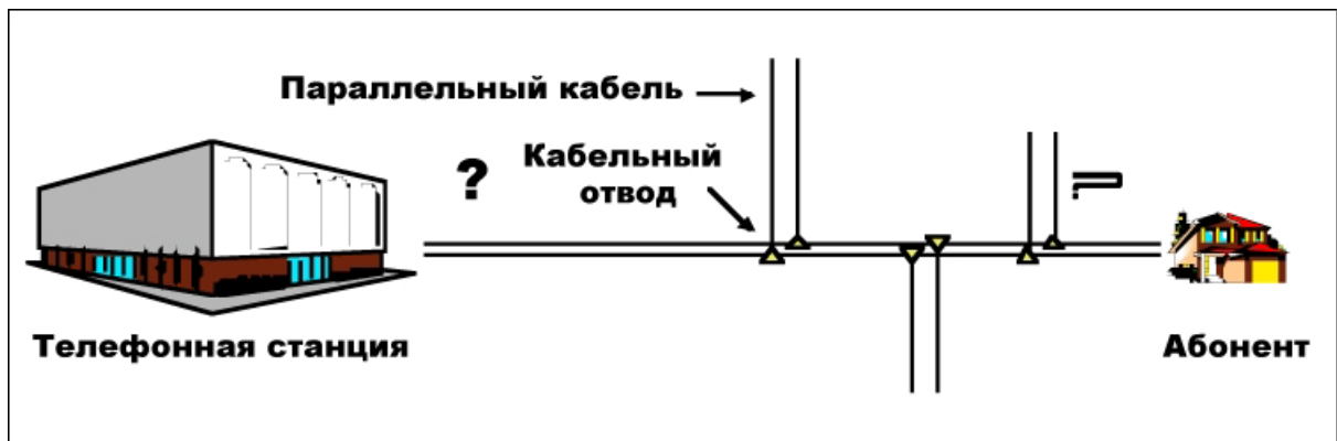
Рисунок 17-16. Ближайший кабельный отвод.
