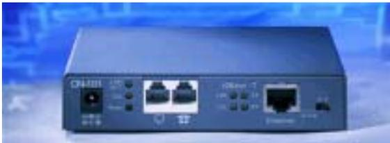
Устройство CN-101 имеет один порт HPNA и один порт 10Base-T Ethernet, что позволяет ему служить в качестве внешнего преобразователя между HPNA Ethernet и 10Base-T Ethernet. Устройство CN-101 представляет собой идеальное решение для перехода от HPNA Ethernet к 10Base-T Ethernet и наоборот. Не требуется никакого программного обеспечения, не
