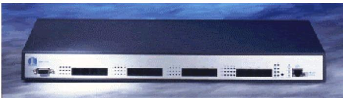
Коммутатор CN-1116 имеет шестнадцать портов HPNA 1 Мбит/с и один порт 10/100 Base-TX. Используя существующую телефонную проводку из витых пар проводов (как включающую в себя УАТС, так и без нее), одно устройство CN-1116 обеспечивает передачу данных для
