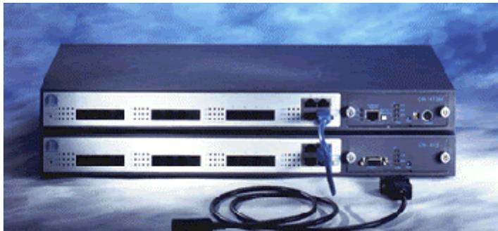
Коммутаторы CN-1412/CN-1412M имеют двенадцать портов HPNA 1 Мбит/с и четыре порта 10/100 Base-TX. Используя существующую телефонную проводку из витых пар проводов (как включающую в себя УАТС, так и без нее), одно устройство CN-1412/CN-1412M обеспечивает передачу данных для двенадцати абонентов со скоростью 1 Мбит/с для каждого, одновременно поддерживая нормальную работу традиционной телефонной связи.
