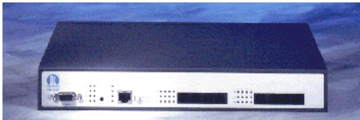
Коммутатор CN-1108 имеет восемь портов HPNA 1 Мбит/с и один порт 10/100 Base-TX. Используя существующую телефонную проводку из витых пар проводов (как включающую в себя УАТС, так и без нее), одно устройство CN-1108 обеспечивает передачу данных для восьми абонентов со скоростью 1 Мбит/с для каждого,
