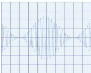
Синусоидальное колебание с амплитудной модуляцией (с помощью входа внешней модуляции).
