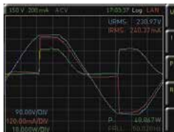
Осциллограмма: нагрузка с фазовым управлением
