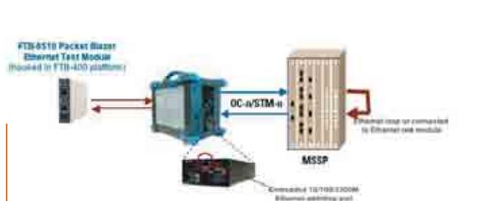
Встроенный интерфейс 10/100/100M Ethernet модуля FTB-8100 позволяет пользователям вводить/выводить Ethernet нагрузку в/из использующих преобразование GFP линий OC-n/STM-n, таким образом обеспечивая мощное решение по тестированию сервисов Ethernet по SONET/SDH.
