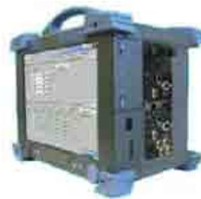
Модули FTB-81X0 устанавливаются в новый восьми-слотовый держатель для Универсальной Измерительной Платформы FTB-400. Такая конфигурация поддерживает несколько модулей FTB-81X0, позволяя одновременное тестирование нескольких портов.
