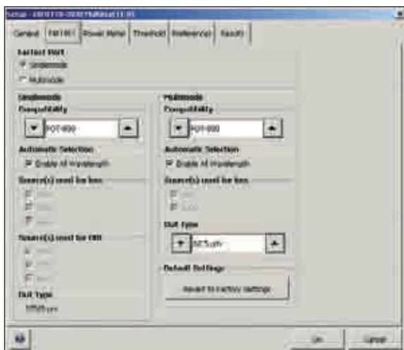
При выполнении измерений FasTest, модуль FTB-3930 может проводить автоматизированные измерения потерь и ORL на всех трех длинах волн и выполнять измерения длины волокна.
