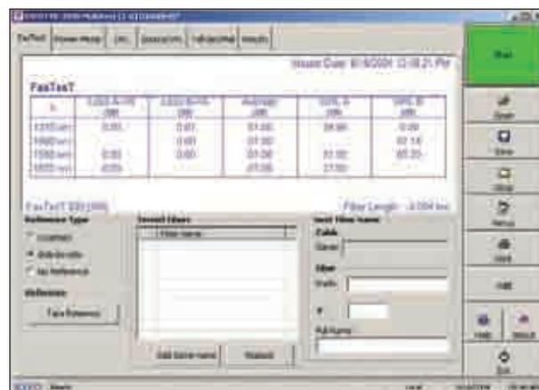
За 10 секунд функция FasTest модуля FTB-3930 проводит измерения значений ORL и потерь на трех длинах волн – включая или 1490 или 1625 нм – на одном выходном порте.
