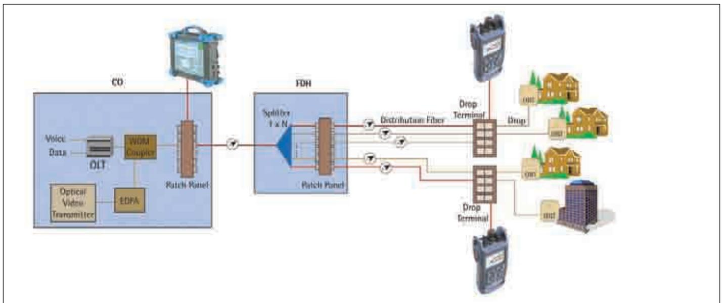
Модуль FTB-3930 позволяет проводить автоматизированное двунаправленное тестирование оптических потерь и ORL пассивных оптических сетей (PON) на длинах 1310 нм, 1490 нм и 1550 нм – трех длинах волн, рекомендованных ITU-T (G.983.3) для PON.
