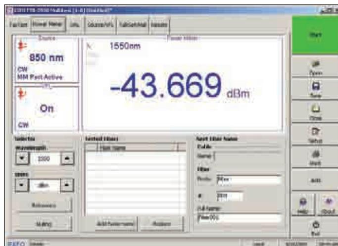
Функции измерителя мощности, источника излучения и дефектоскопа могут быть включены одновременно, и соответствующие данные будут отображаться одновременно.
