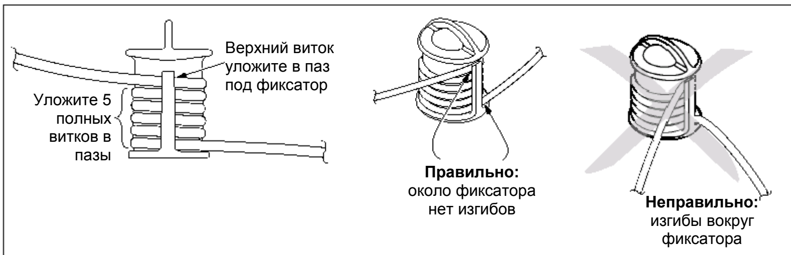
Рисунок 3. Как пользоваться оправками для многомодовых патч-шнуров
