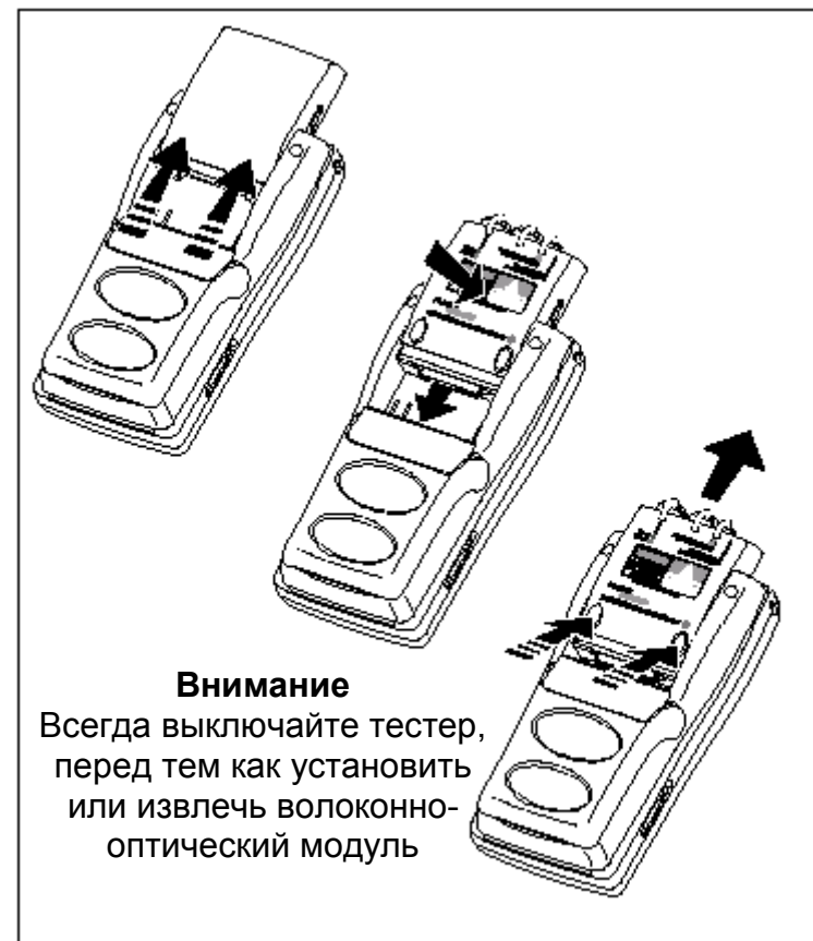
Рисунок 1. Установка и извлечение волоконно-оптических модулей
