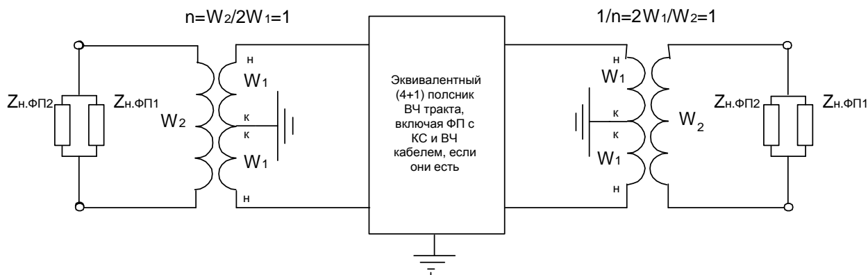
Рисунок 1.2.3. Представление присоединения при расчетах ВЧ тракта со схемой присоединения «два провода – земля».
