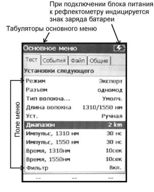
С помощью кнопок (можно переходить из одного экрана основного меню на другие: Тест, События, Файл, Общие (только в Ручном режиме).
