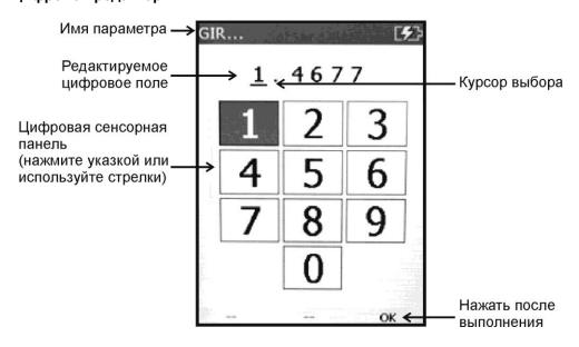
С помощью кнопок ▲ ▼ изменяют значение подчеркнутой цифры. С помощью кнопок ▲ ▼ изменяют позицию подчеркнутой цифры. После окончания редактирования нажмите кнопку ОК.
