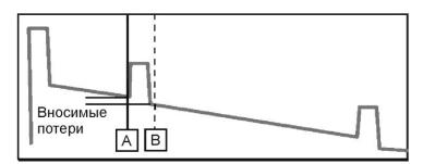
Для измерения конечных потерь линии используйте буферный и приемный кабели. Установите курсор А перед первым событием линии, а курсор В после последнего пика последнего события. Результат измерения прочитайте в окне потерь.
