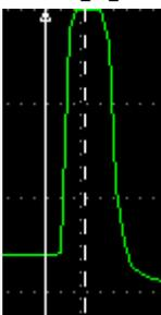
Для измерения коэффициента отражения от разъемного соединения двух ОВ или от конца ОВ следует правый курсор (маркер) установить на вершину отраженного импульса, левый - на участок рефлектограммы непосредственно перед ним (см. рисунок), затем нажать соответствующую кнопку [панели инструментов](#) или выбрать соответствующий пункт меню [режим](#).
