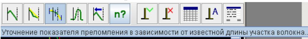
Используя известное расстояние, можно с достаточной точностью определить показатель преломления. Для этого используется специальный режим «Уточнение показателя преломления...».
