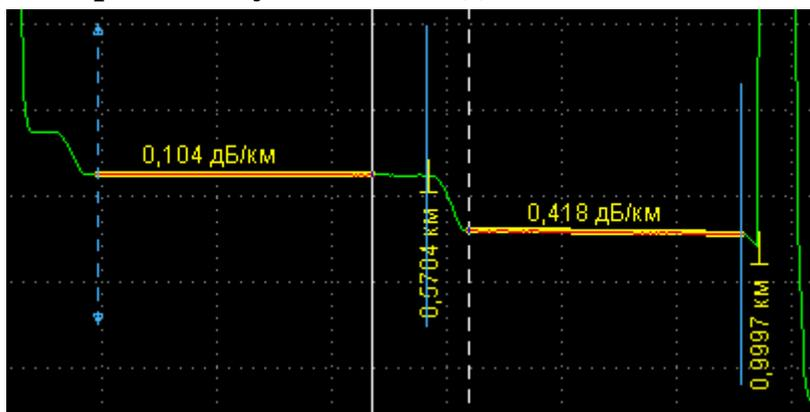
Программа позволяет определить затухание в соединении ОВ методом пяти маркеров (см. рисунок). Для этого следует установить основные курсоры (маркеры **А** и **В**) вблизи места соединения так, чтобы оно оказалось между ними, нажать соответствующую кнопку [панели инструментов](#) или выбрать соответствующий пункт меню [режим](#).
