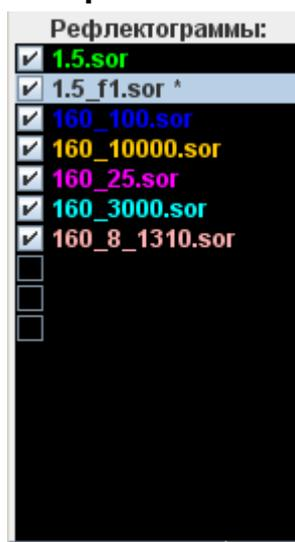
Список загруженных рефлектограмм – элемент управления позволяющий управлять процессами вывода и печати. При помощи данного элемента пользователь может загрузить до десяти рефлектограмм одновременно, например, для их последующего наложения с целью сравнения. Все загруженные рефлектограммы масштабируются по основной рефлектограмме. Основная рефлектограмма – это текущая (выделенная) и отмеченная «птичкой» в списке
