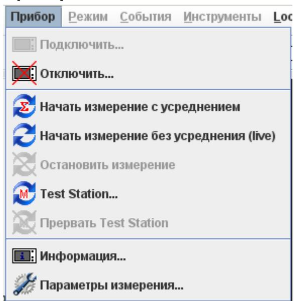
Данный пункт меню предназначен для удалённого управления OTDR фирмы «Связьприбор». При этом сам прибор должен поддерживать функцию удалённого управления.
