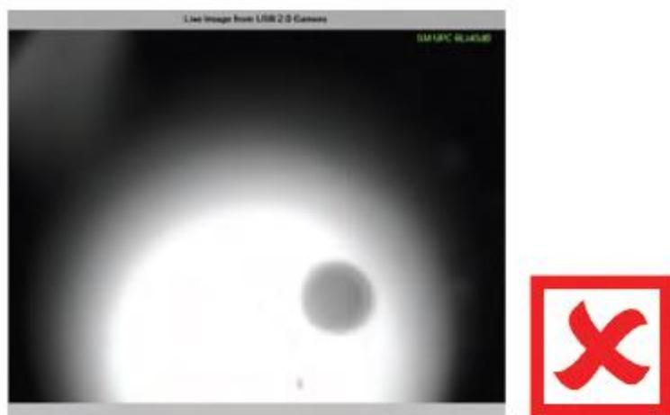
Рисунок 10. Несфокусированный торец оптического волокна
