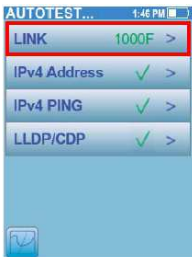
Главный экран прохождения автоматического тестирования
