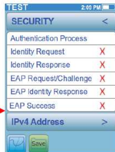
Экран безопасности с сообщением о неисправностях
