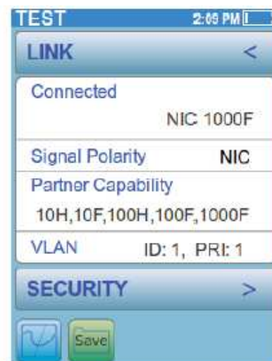
Экран Link с выбранной сетью VLAN
