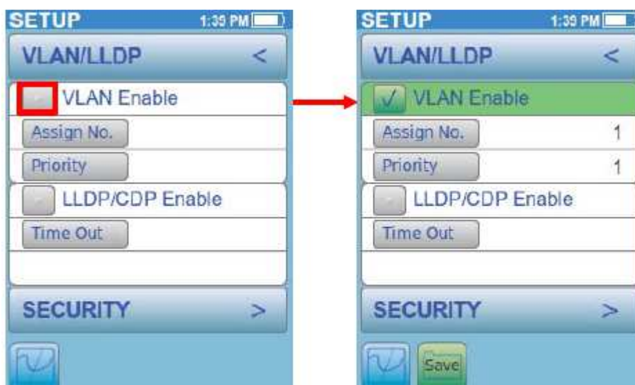
Экран настройки VLAN/LLDP
