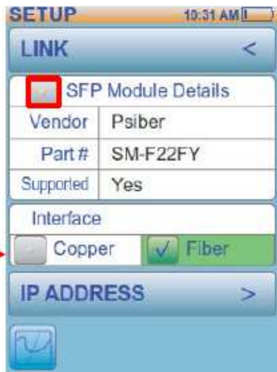
Экран настройки для волоконной линии
