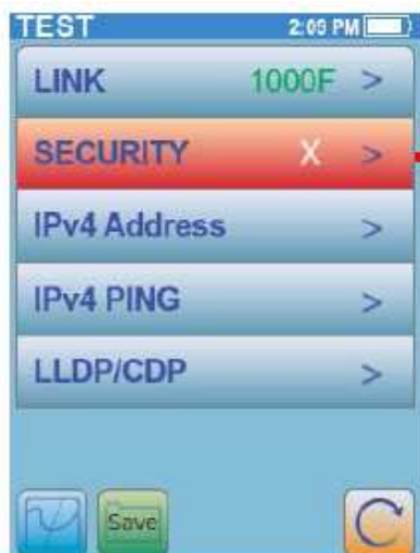
Главный экран автоматического тестирования с неудавшимся этапом
