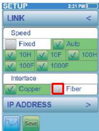
Экран настройки для медной линии
