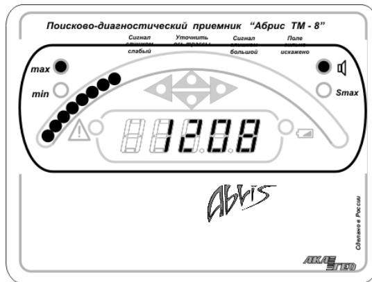
Сверху располагается шкала, работающая слева направо и отображающая текущий уровень сигнала. Если шкала ушла в ноль или упёрлась в максимум, измените усиление
