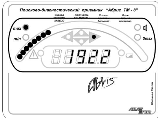
Для перехода в режим поиска по минимуму необходимо нажать на соответствующую кнопку. При этом на шкале высвечиваются 3 сегмента, а их положение указывает с какой стороны и на каком удалении находится ось коммуникации (на рисунке коммуникация находится слева). Стрелки не используются. Цифровое значение соответствует сигналу с вертикальной антенны и над осью должно принимать минимальное значение. Обратный переход в режим поиска по максимуму осуществляется той-же кнопкой.
