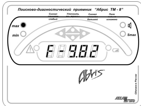
После этого приёмник переходит в режим поиска по методу максимума на той частоте, на которой приёмник использовался в последний раз с выключенным режимом «SuperMax» и автоустановленным усилением.
