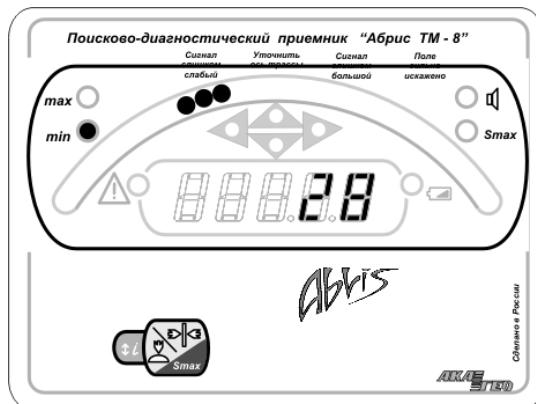
При уходе от оси трассы на значительное расстояние (порядка глубины залегания), а также при сильноискажённом поле или высоком уровне помех приёмник автоматически переходит в режим максимума при этом выдаёт сообщение об ошибке.
