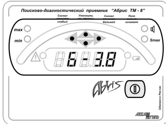
Напряжение батарей держится на экране около 2сек, затем отображается текущая рабочая частота в виде:
