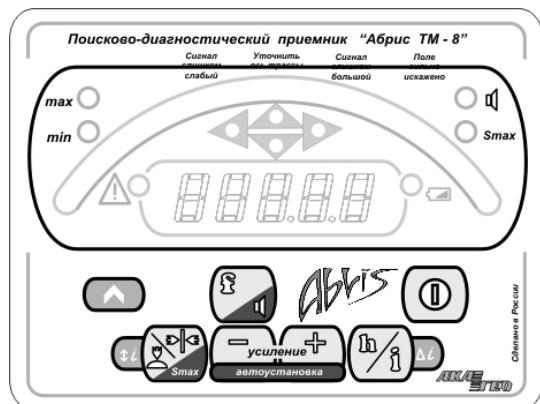
Каждая кнопка может выполнять до 3х функций. При этом обычное нажатие на кнопку активирует основную функцию, обозначенную крупным значком на светлом фоне.
