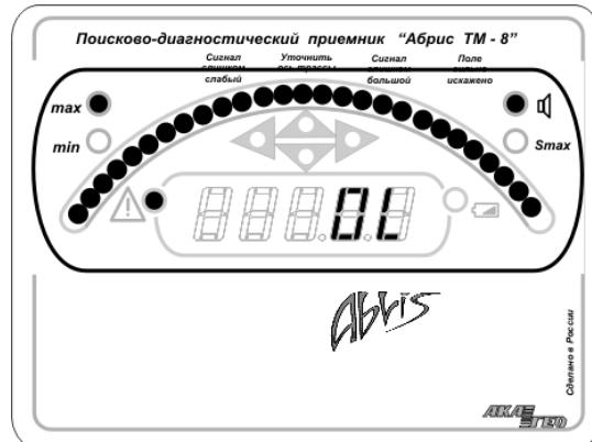
Длительное нажатие на любую из кнопок усиления активирует функцию автовыбора усиления. В течение нескольких секунд приёмник измеряет входные сигналы и сам выбирает оптимальное усиление. Ход процесса отображается шкалой в нижней части экрана. Выбранное усиление отображается на индикаторе. Также, процедура автоустановки усиления запускается автоматически при включении приёмника, изменении рабочей частоты и в некоторых других случаях.
