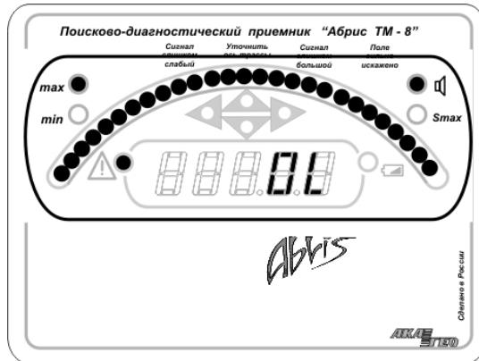
Снизьте усиление. Если перегрузка возникает при относительно малых сигналах, возможно, имеет место сильная сторонняя помеха. Определите и устранит источник помех или перейдите на другую частоту.
