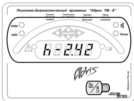
(2м 42см). Обратите внимание, что глубина отсчитывается от **оси** трубопровода до **нижней точки** приёмника. Показания будут держаться на экране около 3х секунд. Если в течение этого времени повторно нажать кнопку, на экране отобразиться измеренный ток в миллиамперах в виде:
