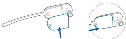
**Внимание.** Этот продукт оснащен заменяемым аккумулятором. Используйте только аккумуляторы, Plantronics.
