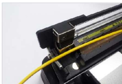
Укладка кабеля в нагреватель – 250, 900, 2.0~ 4.0mm
