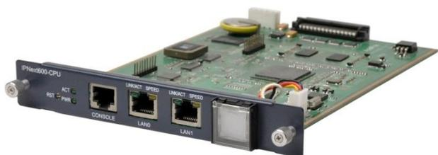
Процессорная карта с возможностью горячей замены (интерфейсы RS232, LAN 10/100TX, WAN 10/100TX)
