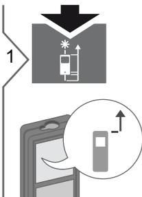
Расстояние измеряется от передней поверхности прибора.
