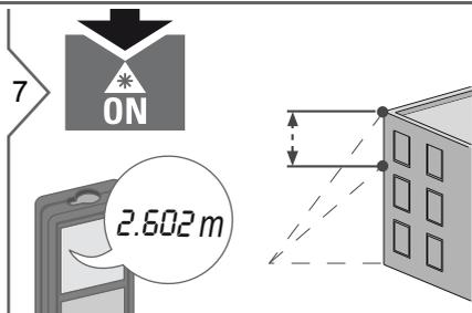
**i** Результат отображается в главной строке, и измеренное расстояние - сверху. Нажатие на клавишу измерения в течение 2 сек активирует автоматическое выполнение измерений минимального и максимального расстояния.
