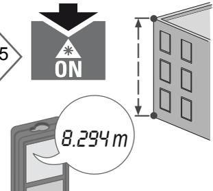
**i** Результат отображается в главной строке, и измеренное расстояние - сверху. Нажатие на клавишу измерения в течение 2 сек активирует автоматическое выполнение измерений минимального и максимального расстояния.
