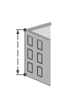
**i** Результат отображается в главной строке, и измеренное расстояние - сверху. Нажатие на клавишу измерения в течение 2 сек активирует автоматическое выполнение измерений минимального и максимального расстояния.
