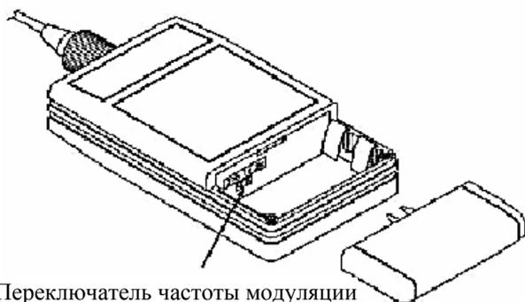
Переключатель частоты модуляции
