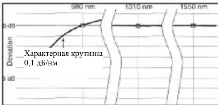
2-миллиметровый измеритель оптической мощности InGaAs 558В откалиброван в соответствии со стандартом NIST на трех длинах волн: 980 нм, 1310 нм и 1550 нм.
