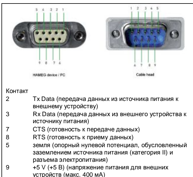
Рис. 6.1 – Назначение контактов интерфейса RS-232
