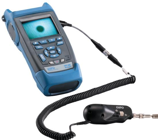
Видеомикроскоп позволяет проводить быструю и легкую оценку торцов волокна или коннекторов, с отображением на экране высокого разрешения FOT-930.
