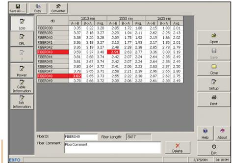
Благодаря программному обеспечению по управлению данными ToolBox Вы получаете более подробное отображение результатов тестирования.
