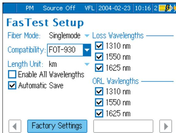
При выполнении измерений FasTest, FOT-930 может проводить автоматизированные измерения потерь и ORL на всех трех длинах волн и выполнять измерения длины волокна.
