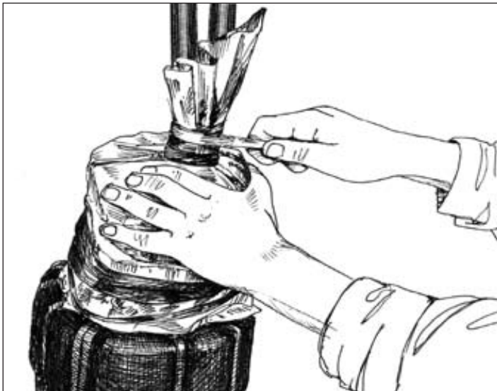
Рис. 3.6. Обмотка полиэтиленового рукава на кабелях ПВХ лентой
