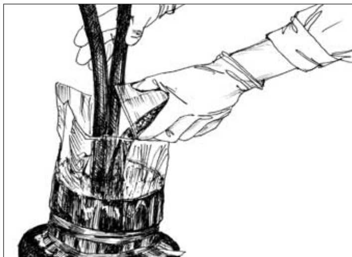
Рис. 3.5. Заливка герметика ВИЛАД-31 в горловину муфты МПЗ
