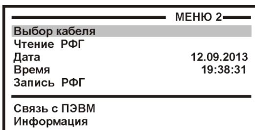
Если кабель не занесен в Список, то в пункте <Выбор кабеля> следует выбрать пустую запись. Например «02-я запись». Выбранная запись помещается в «карман». Для ввода параметров нажмите кнопку [НАСТРОЙКА].
