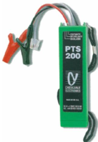
Трассировка линий с помощью тонального генератора и индуктивного щупа – наиболее быстрый способ идентификации кабельных пар. Достаточно подключить генератор к линии и на другом конце идентифицировать ее.
