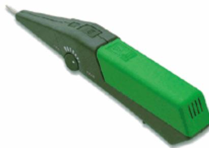
Трассировка линий с помощью тонального генератора и индуктивного щупа – наиболее быстрый способ идентификации кабельных пар. Достаточно подключить генератор к линии и на другом конце идентифицировать ее.
