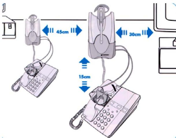
**Внимание!** Для стабильной работы гарнитур базовый блок должен быть установлен:
