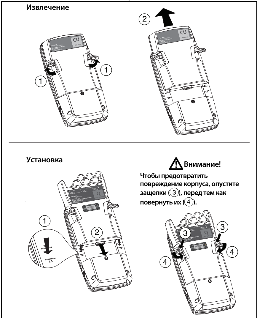
Рис. 6. Извлечение и установка модуля
