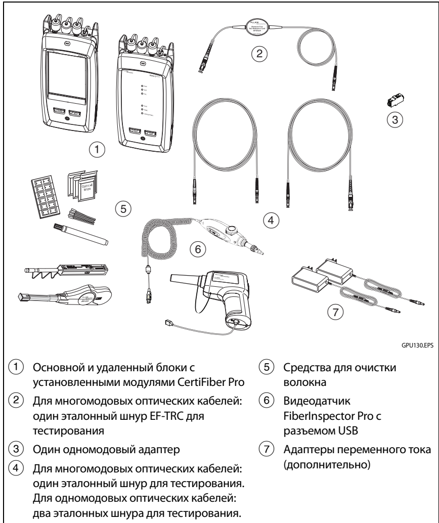
Рис. 66. Оборудование для выполнения автотеста в режиме с источником на дальнем конце
