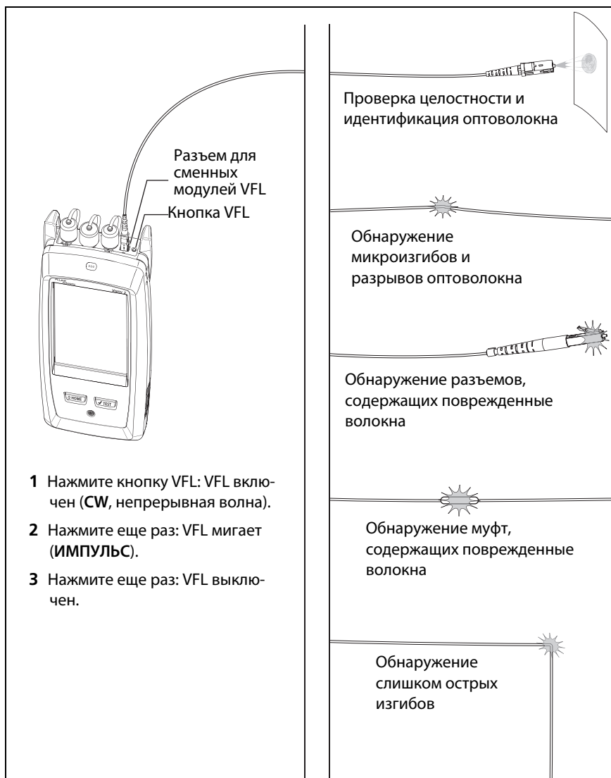
Рис. 120. Использование визуального локалятора повреждений
