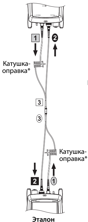
Рис. В-1. Модифицированный метод одной перемычки для режима Smart Remote
