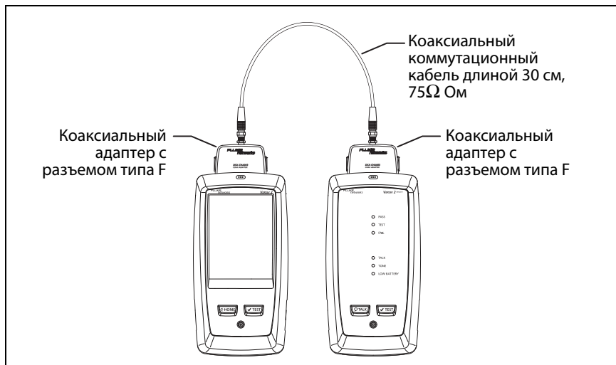
Рис. 28. Эталонные соединения для тестирования коаксиальных кабелей
