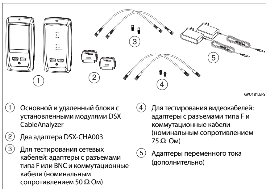
Рис. 29. Оборудование для тестирования коаксиальных кабелей
