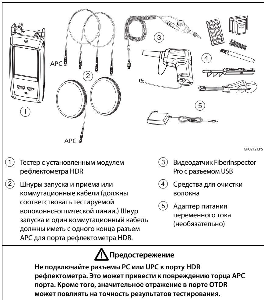
Рис. 106. Оборудование для выполнения теста FaultMap
