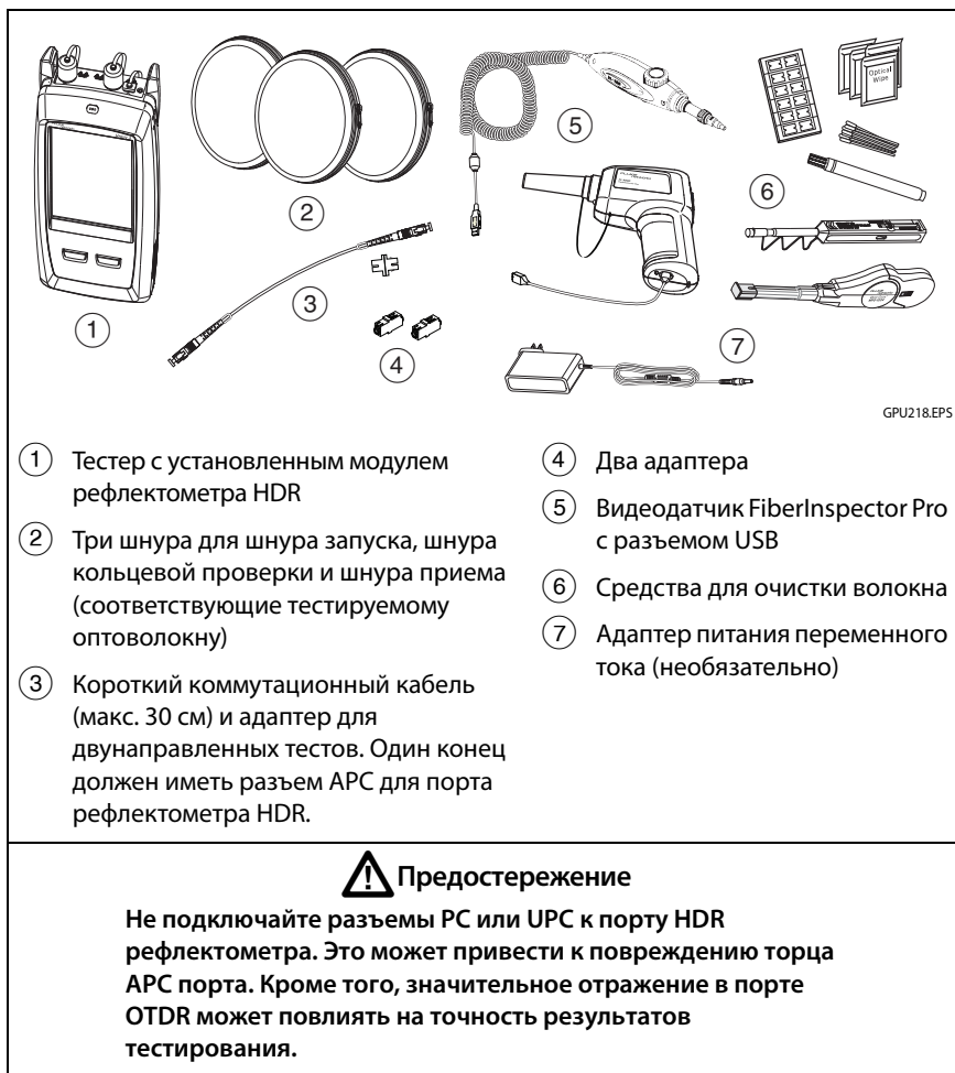
Рис. 109. Оборудование для выполнения теста SmartLoop
