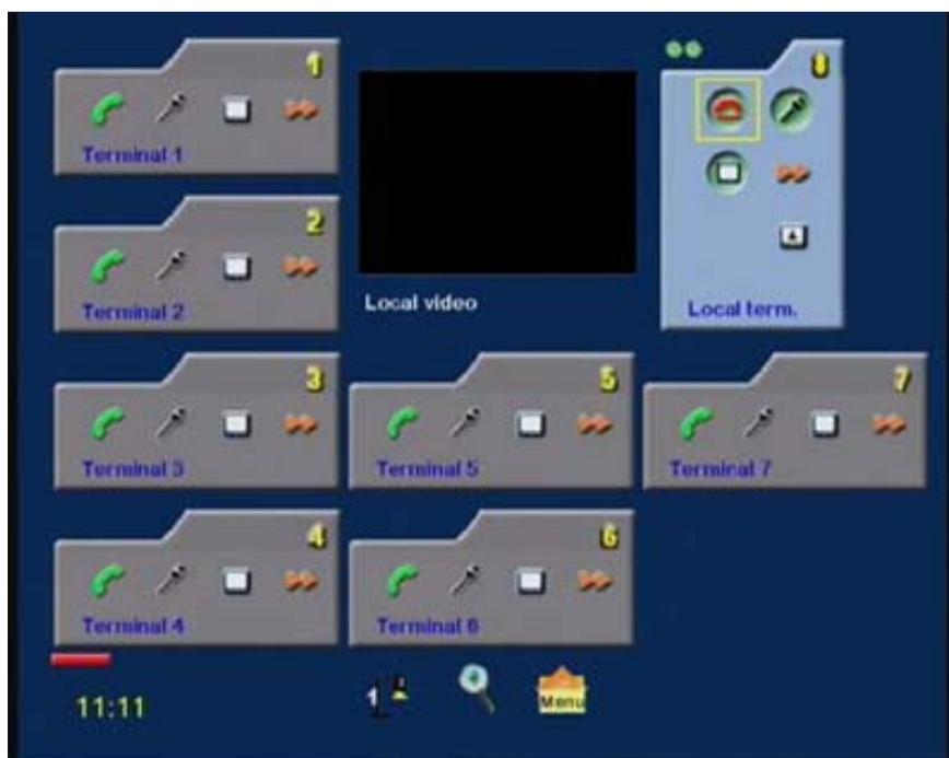
В окне в центре экрана демонстрируется текущее локальное видео. В таблицах ниже показаны различные информационные пиктограммы для локального терминала (программа управления MCU). Часть демонстрируемой информации также действительна для других подключенных терминалов.
