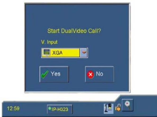
Когда активирован режим Dual Video, если принимающий терминал имеет два монитора, пользователь сможет просматривать оба видеосигнала одновременно. Если же имеется только один монитор, пользователь сможет переключаться между видеосигналами, нажимая кнопку "SELF" на пульте дистанционного управления.
