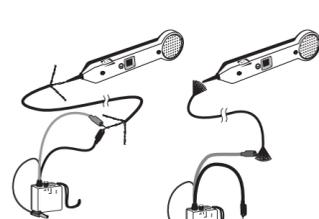
Figura 2a. Rastreamento de pares
