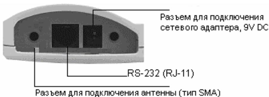
**Рисунок 50: Нижняя панель SMS Transmitter**
